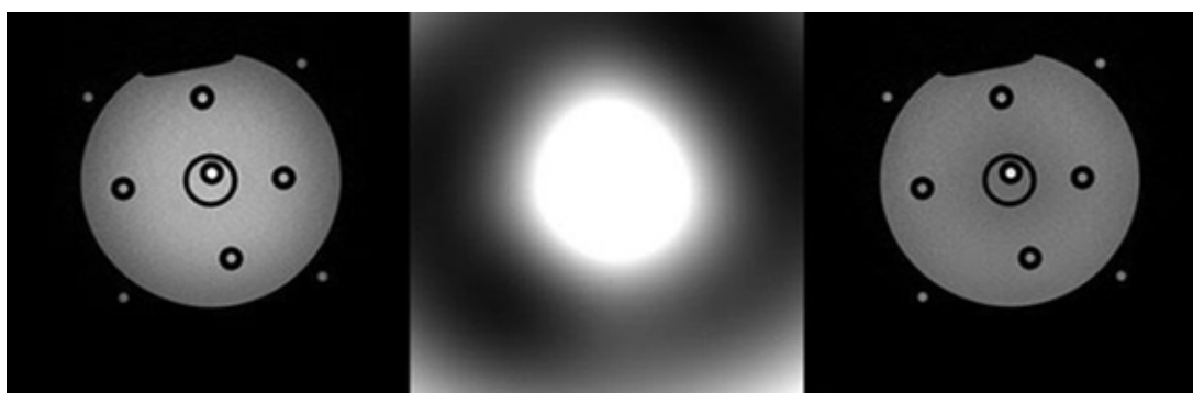
Figura 10: a) Imagem original de RM, b) Filtro de correção e c) Imagem já corrigida (ZAPAROLI et al., 2021)
