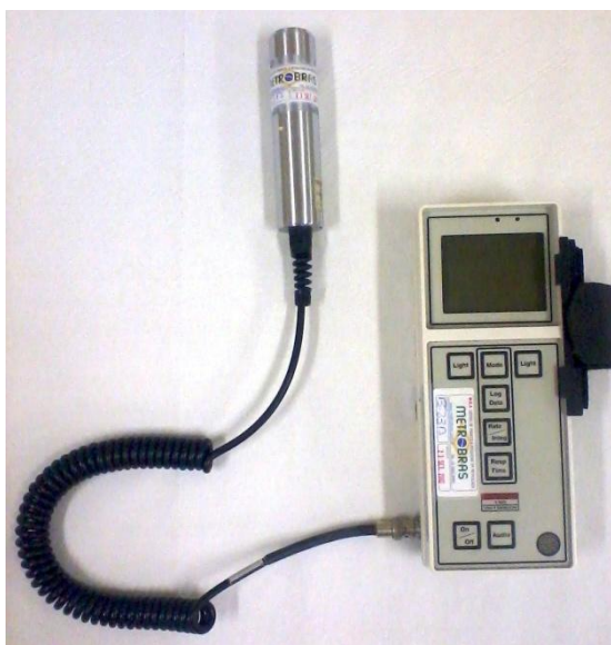
Figura 1. Medidor Geiger-Muller acoplado de sonda cilíndrica.
