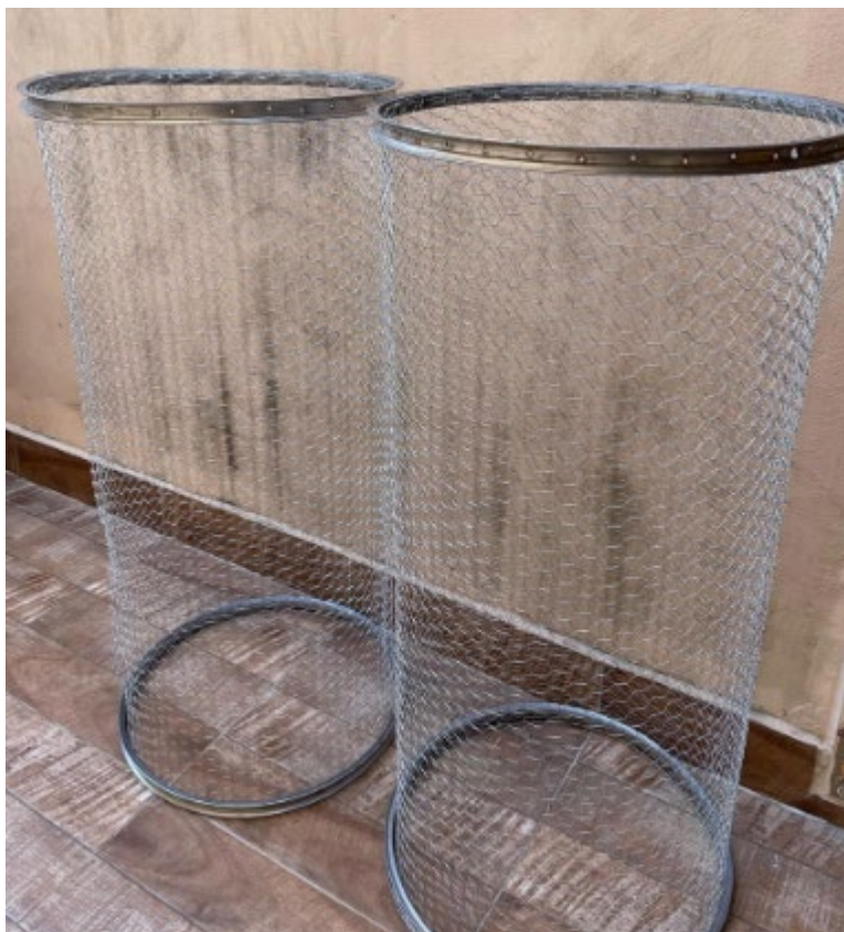
Figura 5 – Duas estruturas cilíndricas produzidas com aros reaproveitados e tela galvanizada.
