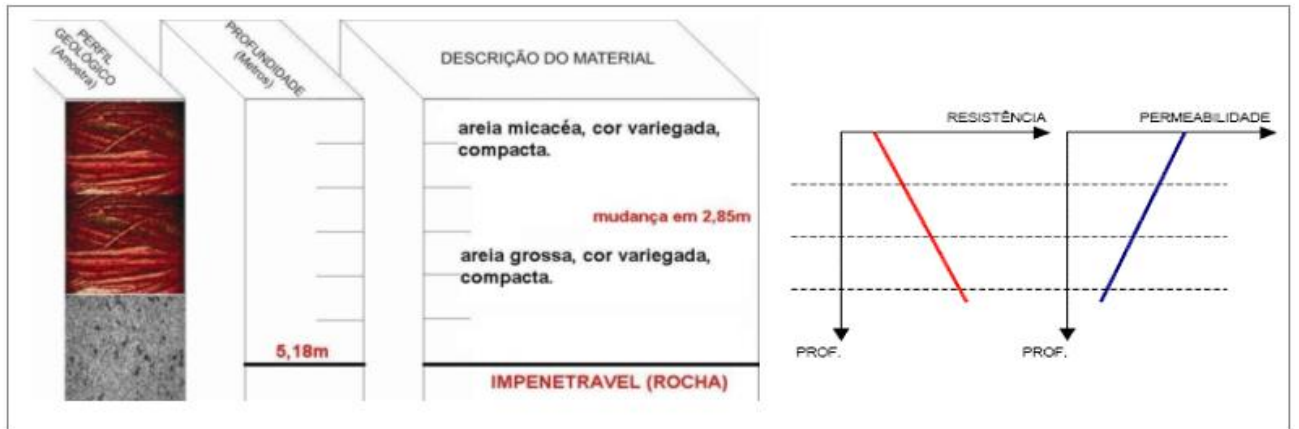
Figura 23 - Perfil do solo residual encontrado pela sondagem local
