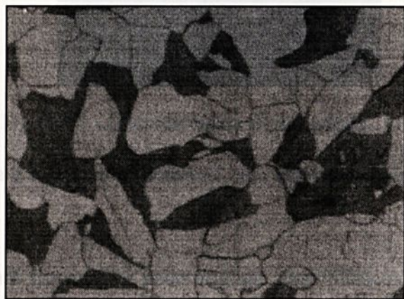
Figura 02 - Microestrutura da ferrita . [10]
