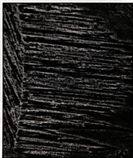
Figura 06 - Microestrutura da bainita . [10]
