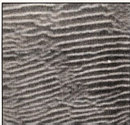
Figura 07 - Microestrutura da perlita . [10]
