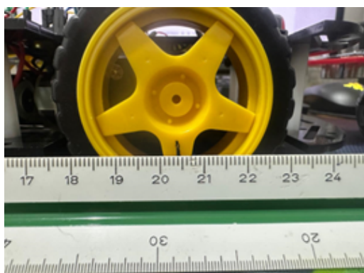
Figura 32 – Configuração experimental para teste de distância percorrida por rotação da roda.
