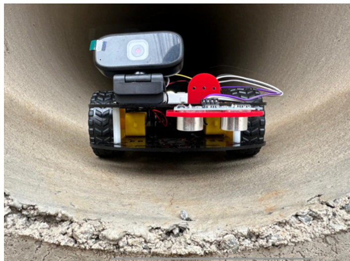
Figura 21 – Sensor ultrassônico instalado no robô.
