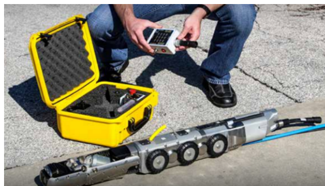
Figura 7 – Robô de inspeção Redikit.
