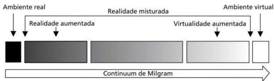
Figura 3 - Contínuo Real-Virtual, conforme proposta por Milgram et al (Milgram et al., 1994).
