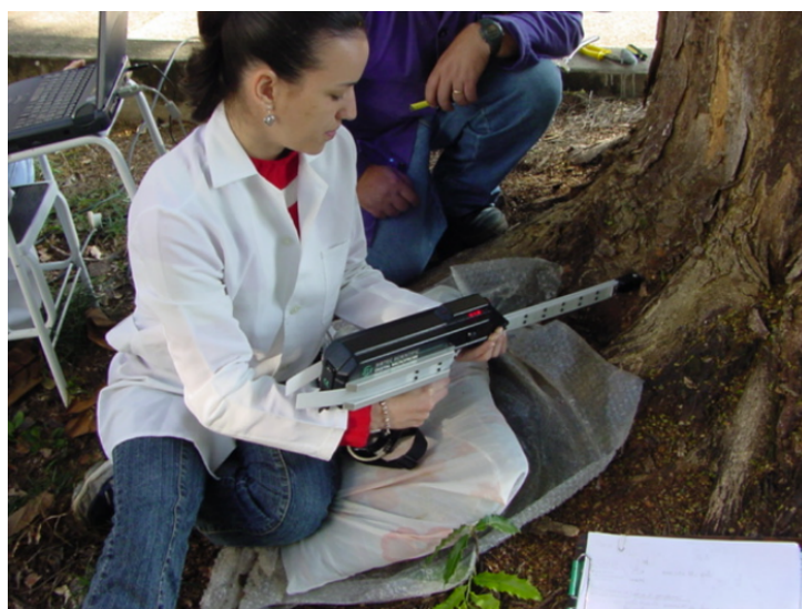
Figura 6 – Uso do penetrômetro Digital Micro Probe® da Sibtec para avaliar a perda de resistência mecânica em um tronco de Tipuana tipu .
