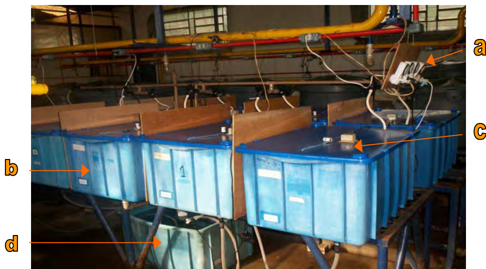
Figura 2: Sistema de recirculação, composto por: (a) timers analógicos; (b) caixas de polietileno; (c) tampa de polietileno com conjunto de lâmpada fluorescente e reatores; (d) caixa de polietileno contendo bomba de recirculação e aquecedores.
