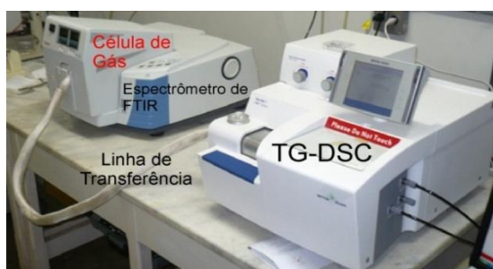
Figura 7 - Sistema TG-DSC-FTIR utilizado na identificação dos produtos gasosos.
