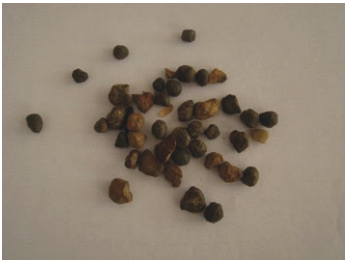
Figura 112: Pedras de óxido de ferro e manganês. Essas pedras moles são utilizadas para a fabricação das tintas cerâmicas depois de trituradas.
