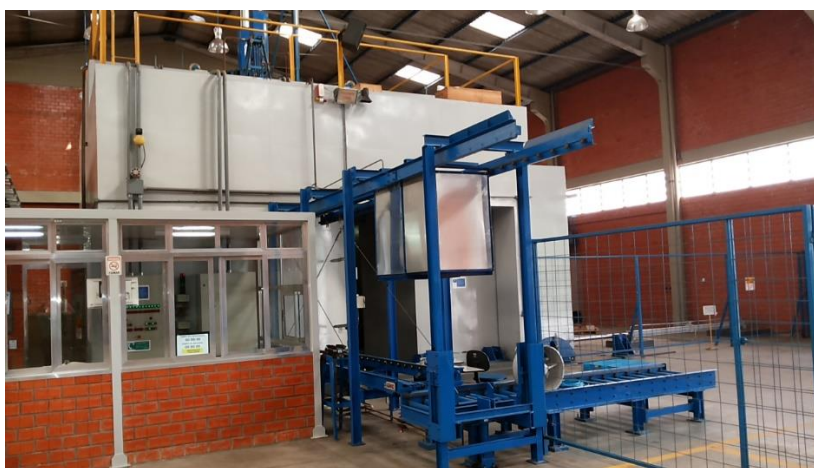
Figura 3. Irradiador Multipropósito de Cobalto-60, Centro de Tecnologia das Radiações (CTR) do Instituto de Pesquisas Energéticas e Nucleares (IPEN/USP).
