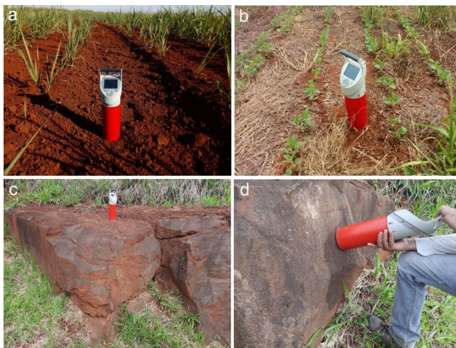
Figura 45: Aquisição gamaespectrométrica nas vertentes da AU de estudo, em local de plantio de cana-de-açúcar (a) e soja (b), além de leituras em afloramento de diabásio inalterado da Fm. Serra Geral (c e d), localizado no km 01 da Rodovia dos Bandeirantes.
