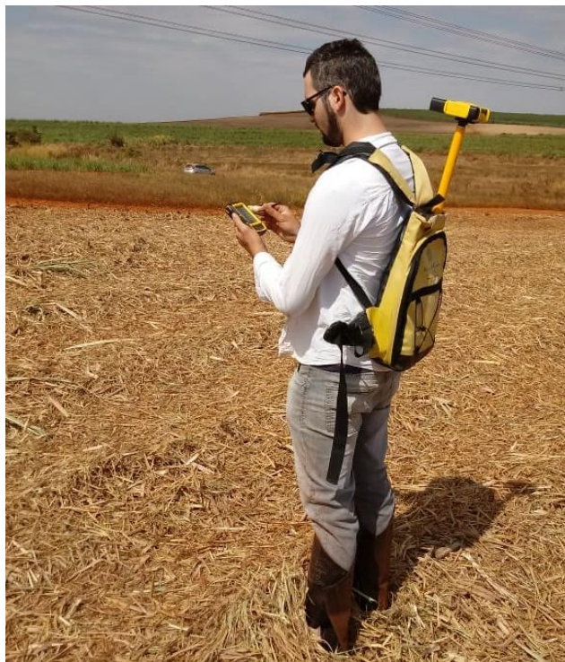
Figura 41: Aquisição de dados de altimetria por GPS de precisão, com detalhe para a antena receptora.
