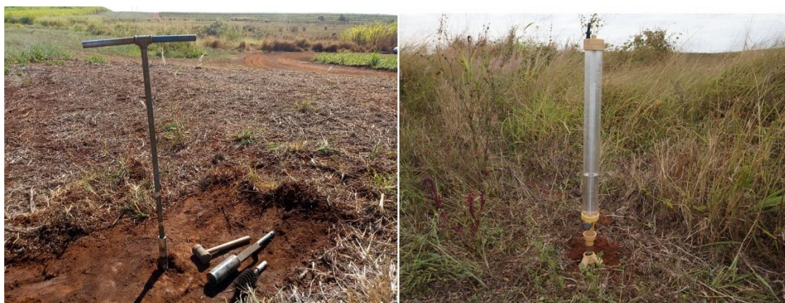
Figura 48: Tradagem do furo de instalação do equipamento e o Permeômetro Guelph em operação no interior da AU.
