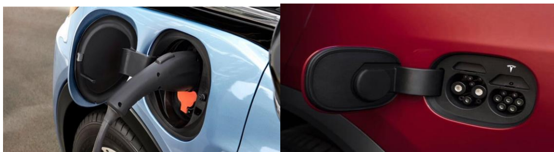
Figura 21 – Veículo com uma entrada de energia e duas entradas.
