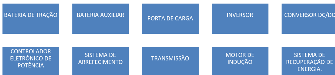
Figura 1 – Diagrama de blocos dos componentes de um veículo elétrico.
