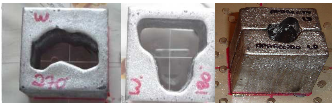
Figura 11 - Blocos de Cerrobend utilizados na Radioterapia Conformacional.
