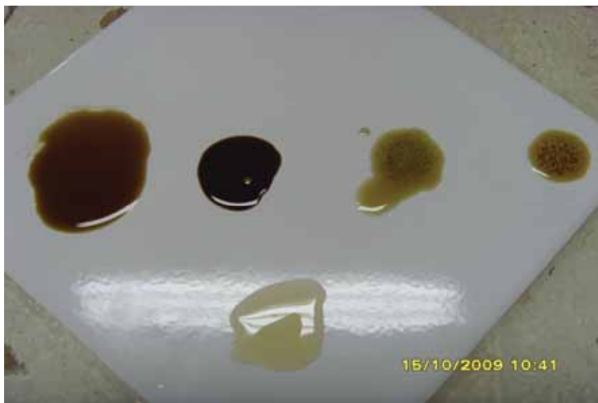
Figura 14. Da esquerda para a direita: 1º- óleo lubrificante usado (antes de iniciar qualquer etapa do tratamento), 2º- óleo neutro pesado com a parte asfáltica, 3º- óleo neutro médio obtido após a destilação a 260°C antes do tratamento químico, por último na direita hidrocarbonetos leves e água obtidos na destilação a 180°C. A mancha abaixo é uma amostra de óleo lubrificante novo aditivado.
