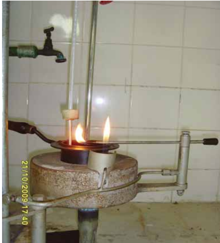
Figura 8. Equipamento utilizado para a medição do ponto de fulgor.
