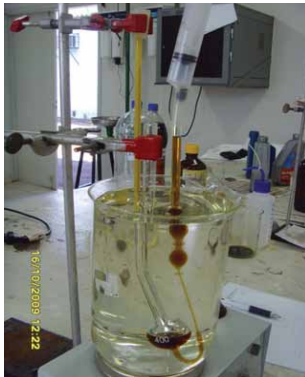
Figura 9. Aparatos para medição da viscosidade cinemática.
