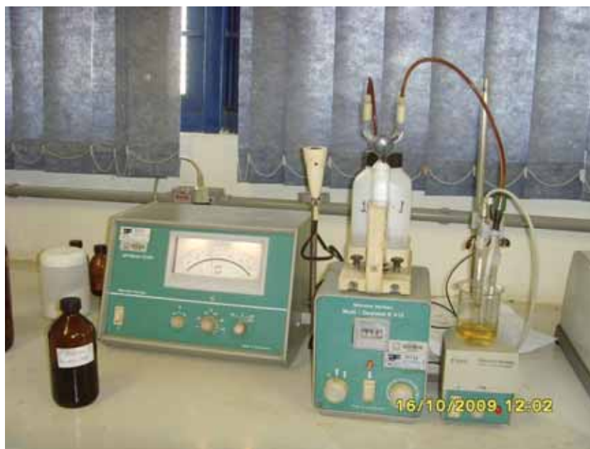
Figura 10. Sistema utilizado para a medição do índice de acidez.
