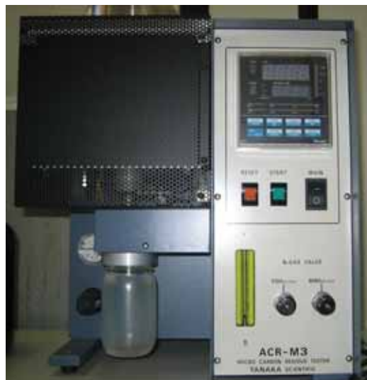
Figura 11. Equipamento utilizado para a determinação do teor de resíduo de carbono.
