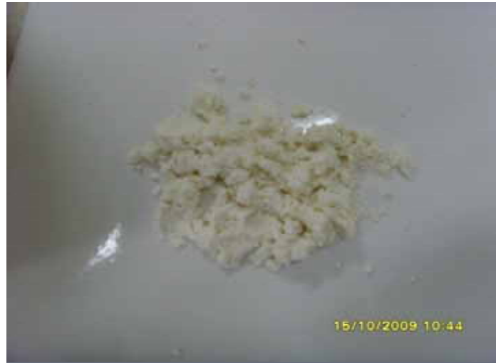
Figura 5. Terra diatomácea ou Terra Fuller, reagente clarificante.
