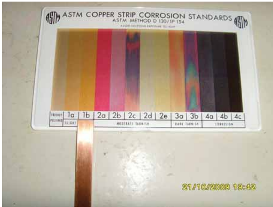
Figura 17. Gabarito da ASTM de corrosividade ao cobre. Abaixo a placa de cobre que ficou imersa durante o teste.
