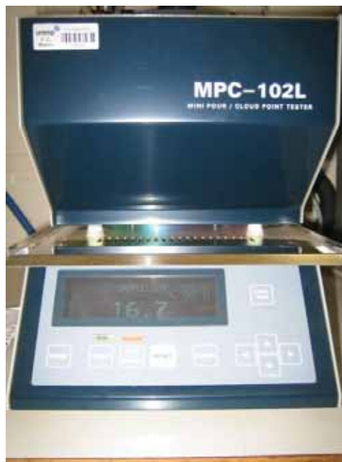
Figura 7. Equipamento utilizado para a medição do ponto de fluidez.
