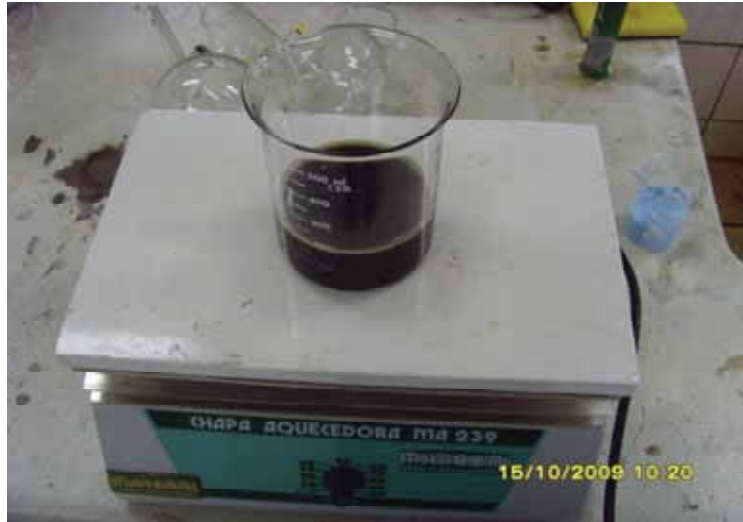
Figura 13. Óleo com ácido sulfúrico em aquecimento.
