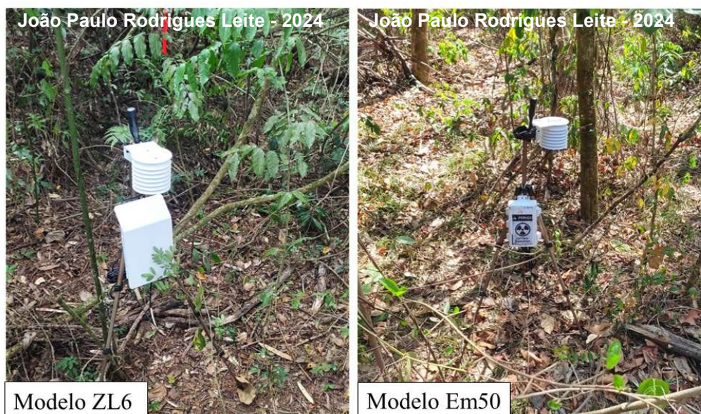
Figura 7 - Medição das variáveis ambientais em parcelas de restauração e referência. A imagem mostra sensores conectados a data-loggers utilizados para o monitoramento da temperatura do ar (°C) e umidade relativa (%).
