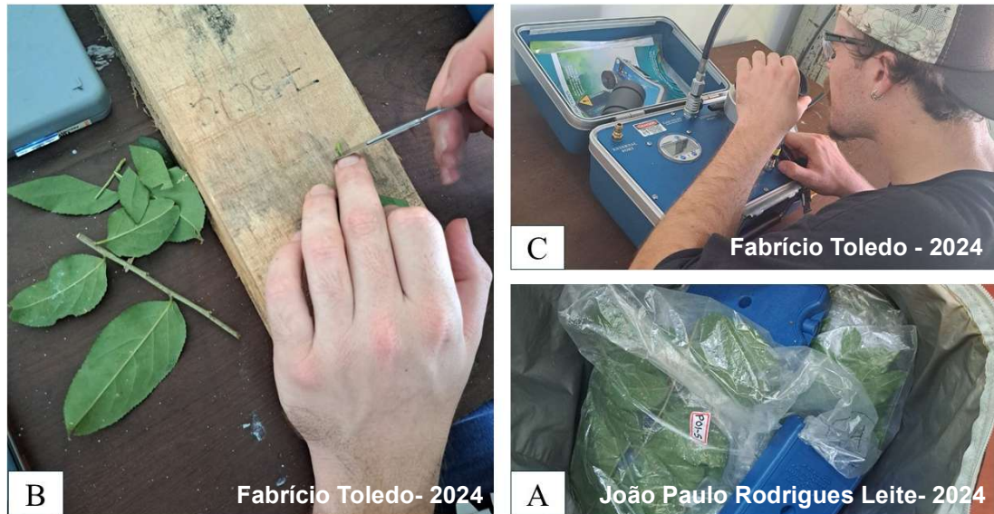
Figura 9 - Medição do potencial hídrico foliar com câmara de pressão do tipo Scholander. (A) Folhas armazenadas em sacos plásticos vedados com gelo. (B) Corte dos pecíolos com bisturi para desobstrução dos vasos do xilema. (C) Medição do potencial hídrico ao meio-dia com a câmara de Scholander.
