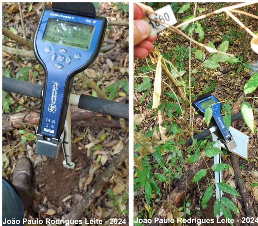
Figura 6 - Medição da umidade do solo utilizando o HydroSense II, acoplado a sensor de capacitância. A imagem mostra o sensor inserido no solo, próximo a um indivíduo selecionado para as avaliações ecofisiológicas.
