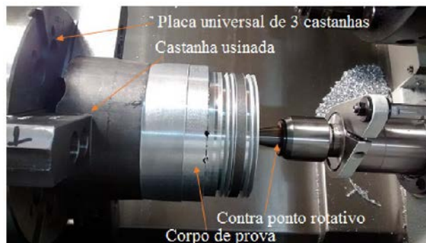
Figura 13 – Dispositivos de fixação utilizados nos ensaios de usinagem.
