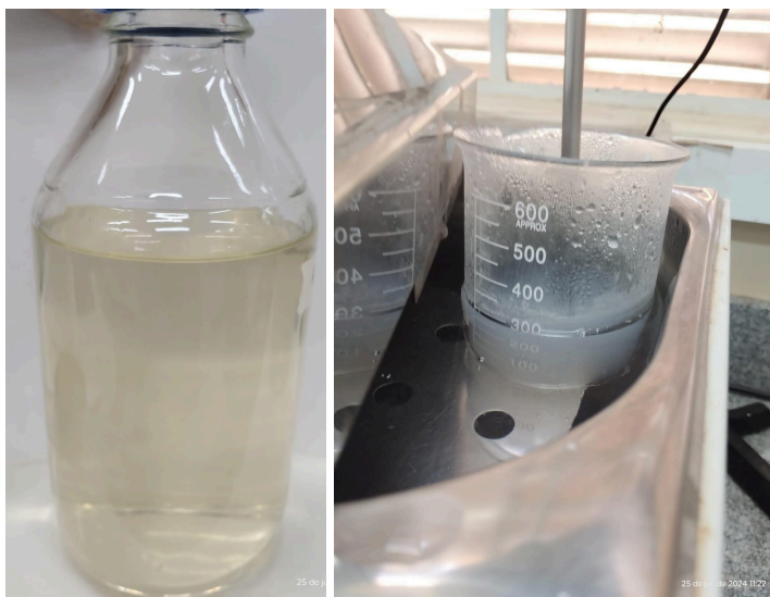
Figura 4 – a esquerda, gel de Quitosana pronto para formar filme e a esquerda, gel de amido em banho termostático com agitação.
