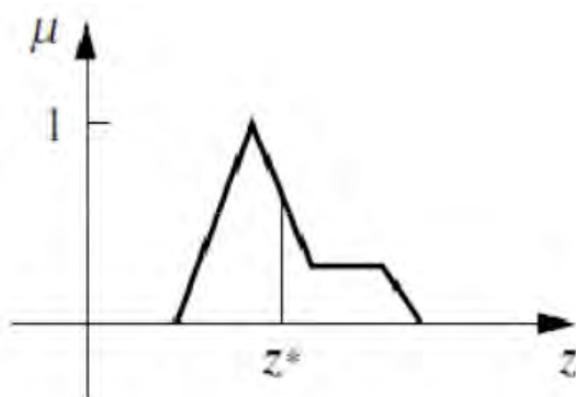
Figura 10. Defuzzificação pelo método do Centro de Área (ROSS, 2004).
