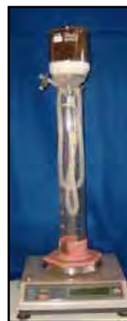
Figura 4: Detalhe do procedimento de pesagem do conjunto de funil de placa porosa com substrato.
