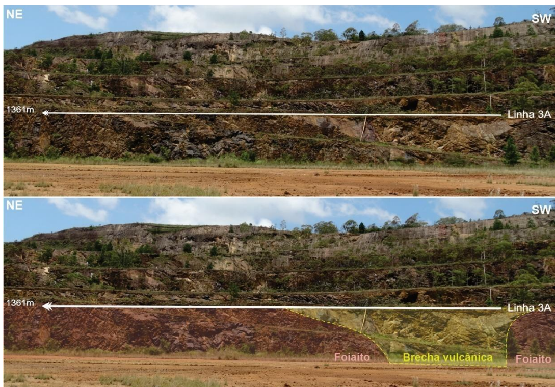
Figura 8 - Litologias delimitadas no reconhecimento geológico com ênfase para brecha vulcânica em amarelo e foiaito em vermelho, presentes em frente de lavra no setor A.
