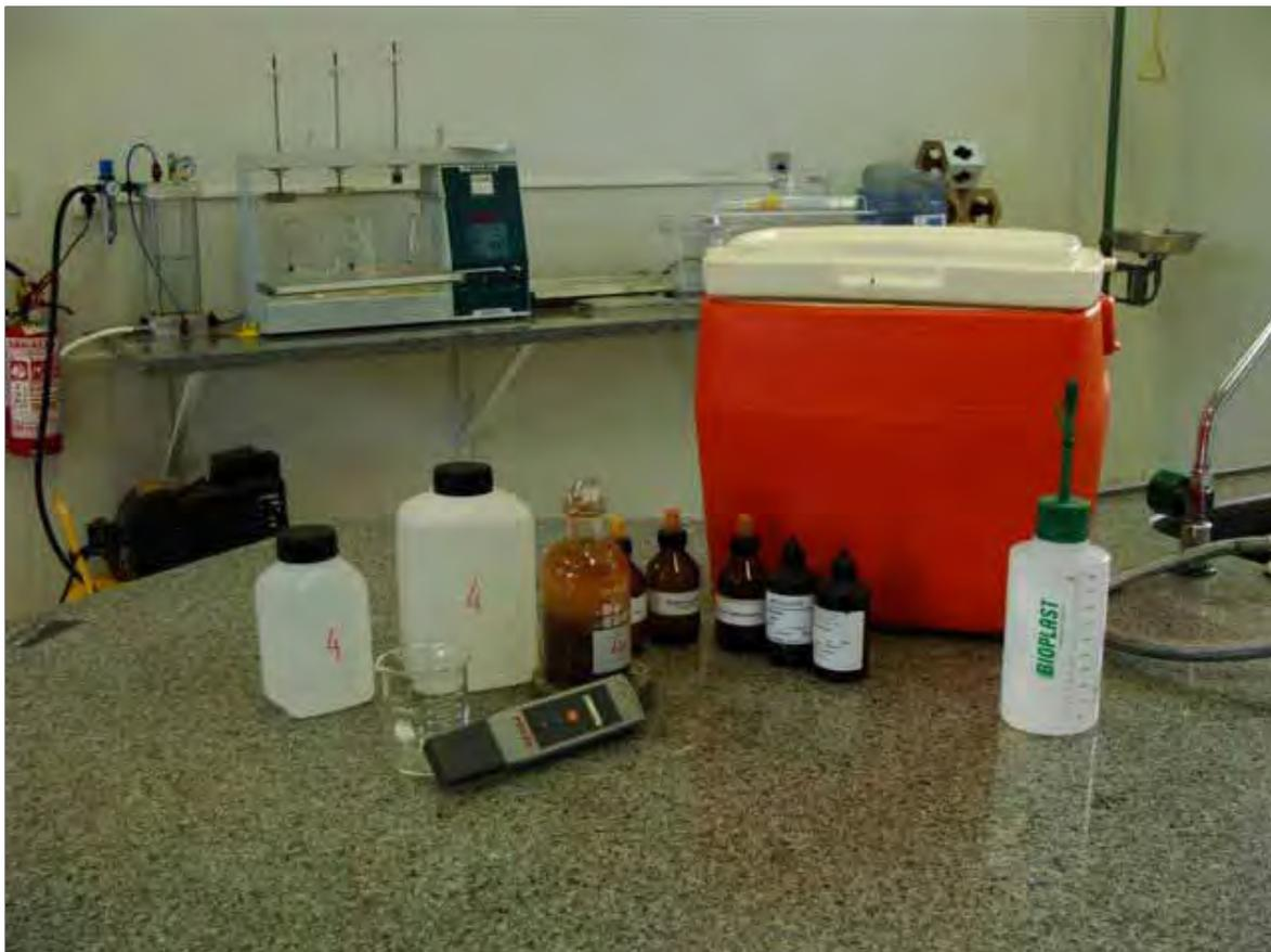
Figura 39 – Frascos e caixa térmica utilizados para armazenamento das amostras.
