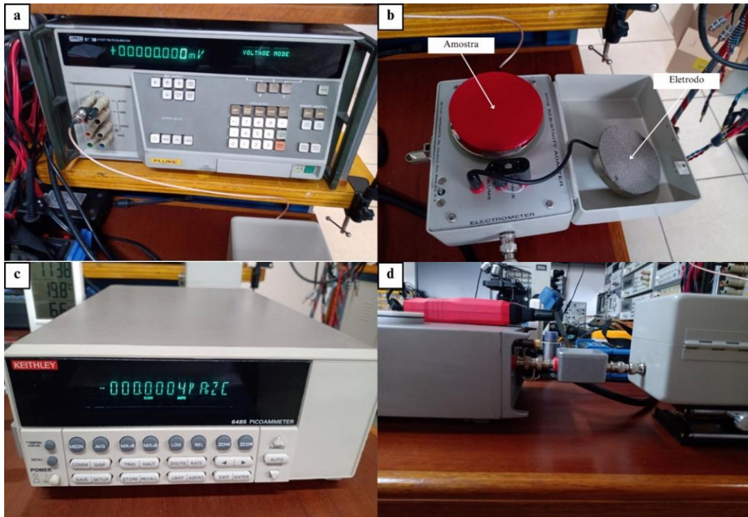
Figura 7 - Visão geral dos equipamentos que compõem o sistema de medição: (a) Calibrador de tensão DC Fluke 5440B, (b) Adaptador de Resistividade Modelo 6105, (c) Picoamperímetro Modelo 6485, (d) Circuito de proteção para sobrecarga elétrica entre Adaptador de Resistividade Modelo 6105 e Picoamperímetro Modelo 6485.
