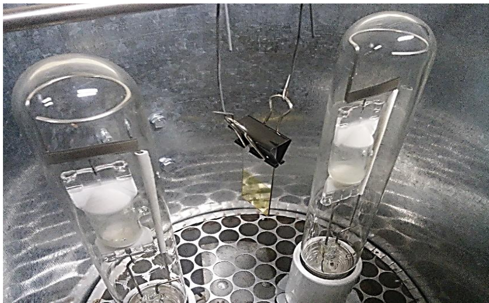
Figura 21 - Disposição do filme no interior do dispositivo UV.
