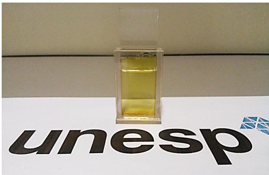
Figura 22 - Imersão da Amostra GTD-Ag (Filme) em H_2O_2 (concentração de 3%), por período de 1min em 1 min.
