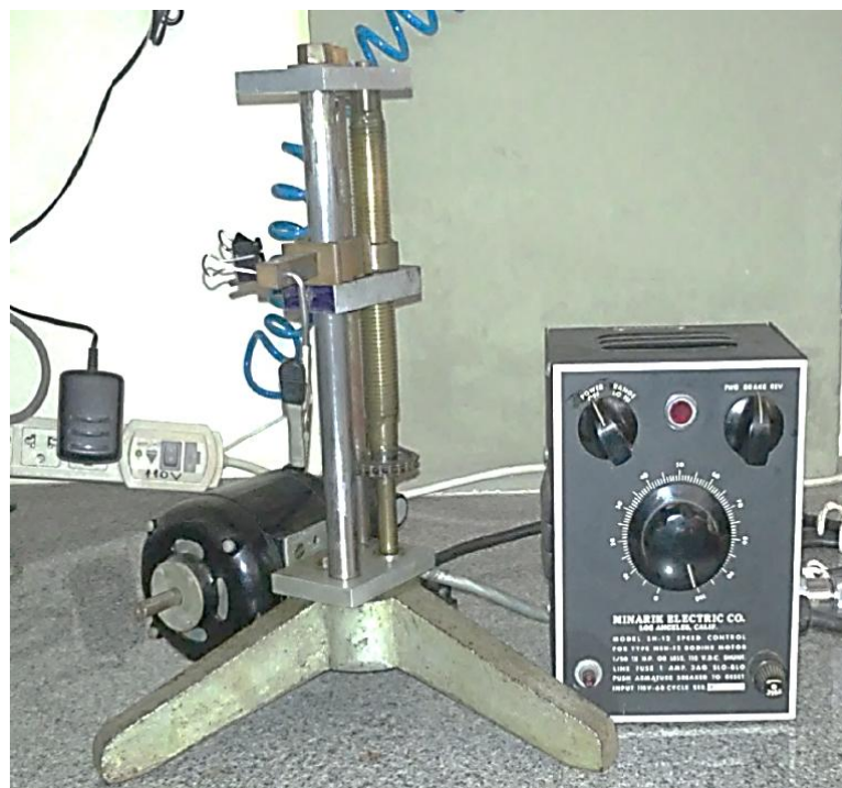
Figura 8 - Equipamento utilizado para o Dip-Coating em Atmosfera Ambiente com velocidade de imersão e emersão de 10 mm/s.
