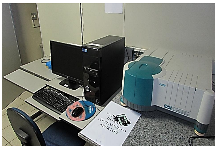
Figura 19 - Equipamento Varian Cary 50 utilizado para a técnica de espectroscopia UV-VIS.
