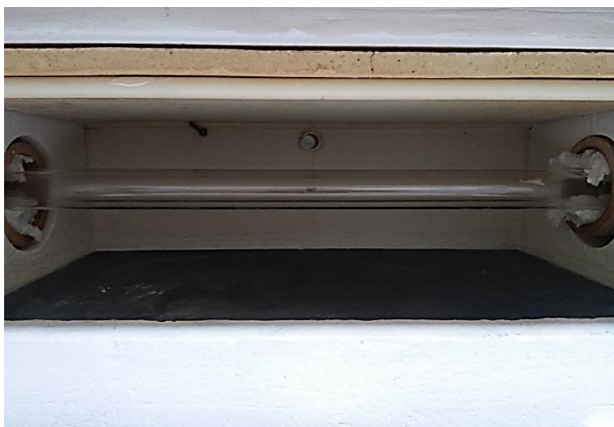
Figura 24 - Tubos de quartzo onde há a exposição dos filmes a altas temperaturas, por onde percorrem as atmosferas (ambiente e N_2 ).
