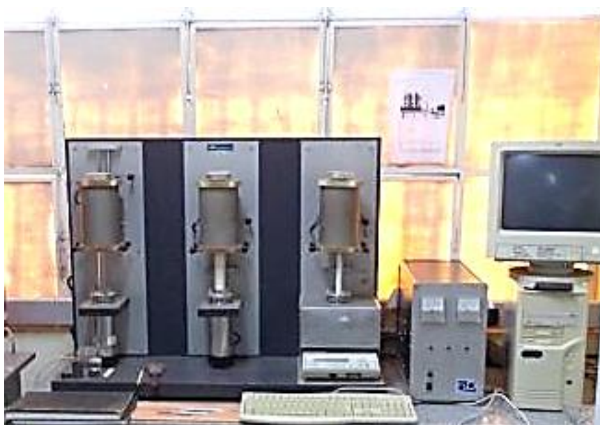
Figura 25 - Equipamento da DTA utilizado para a obtenção dos Termogramas para a atmosfera ambiente.
