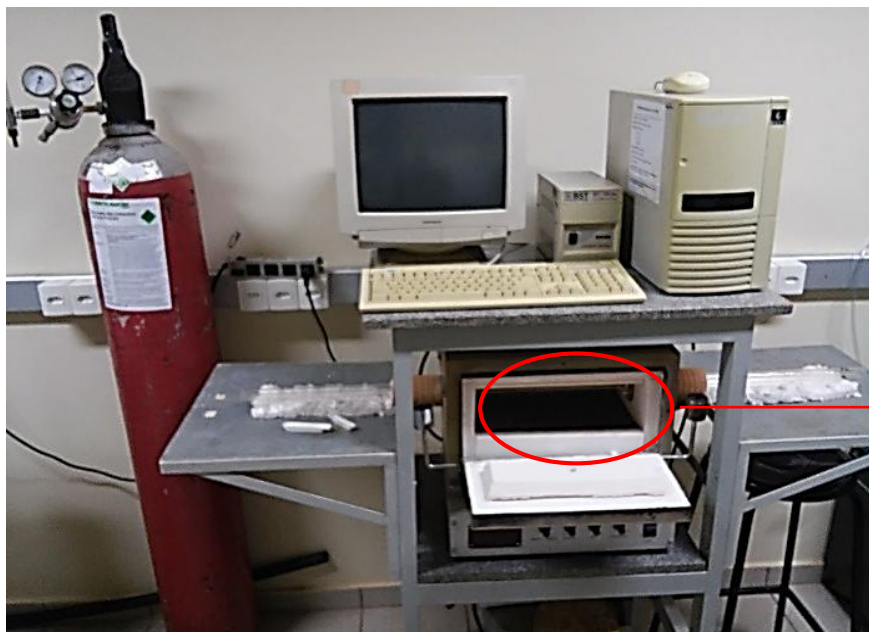
Figura 23 - Forno convencional utilizado para o tratamento térmico das amostras GTD-Ag (Filme).
