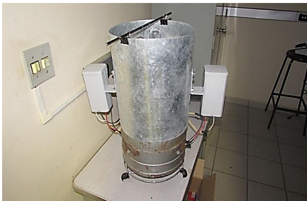
Figura 20 - Dispositivo UV desenvolvido para tratamento das amostras GTD-Ag (Filme).
