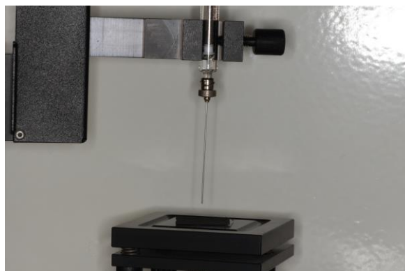
Figura 5 – Medidor de ângulo de contato, goniômetro
