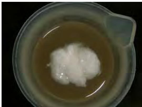
Figura 3. Isolamento do EPS com álcool anidro (4°C).
