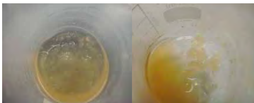
Figura 25. Exopolissacarídeos produzidos por Lactobacillus helveticus em LDR 10% acrescido de 2% de frutose e extrato de levedura, a 37°C e 100 rpm, e após precipitação com álcool anidro (4°C).
