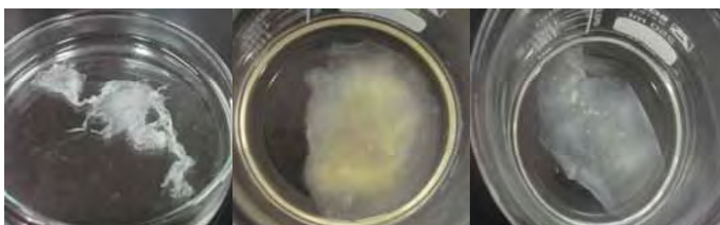
Figura 26. Exopolissacarídeos produzidos por Lactobacillus helveticus em LDR 10% acrescido de 2% de glicose e extrato de levedura, a 37°C e 100 rpm, e após a secagem e posterior rehidratação.
