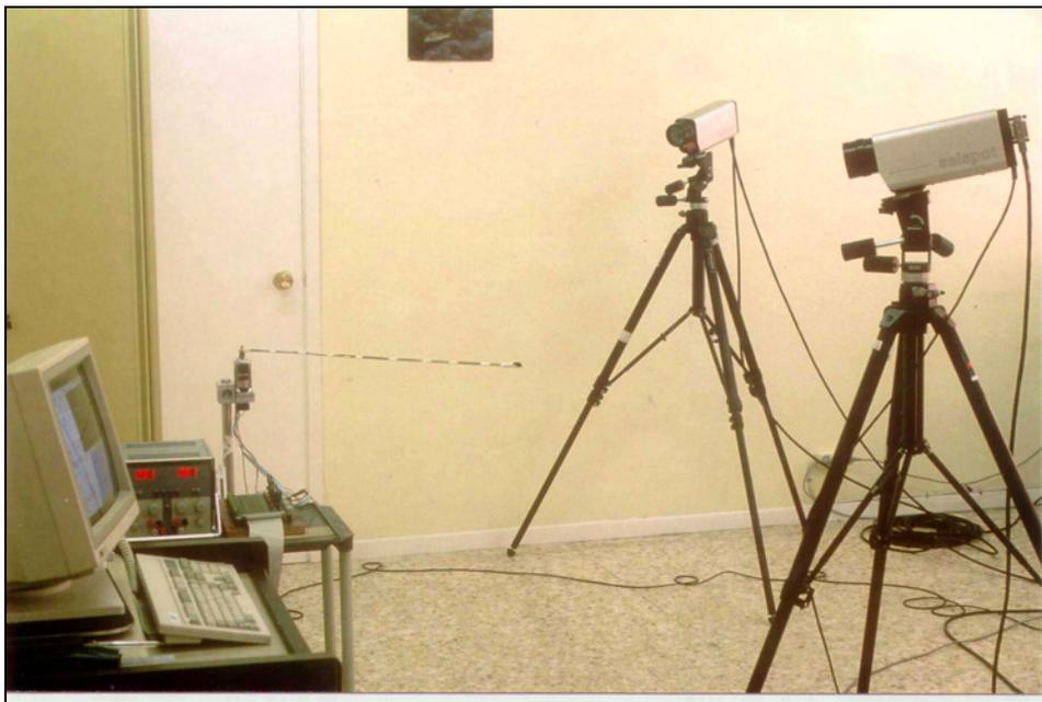
Figura 3.5 – Protótipo experimental com o sistema *SELSPOT II* (GAMARRA ROSADO *et al.*, 1996).
