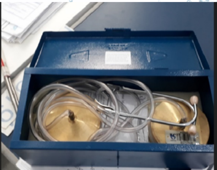
Figura 7 - Geofone eletrônico e mecânico utilizado pela Sabesp de Fernandópolis - SP
