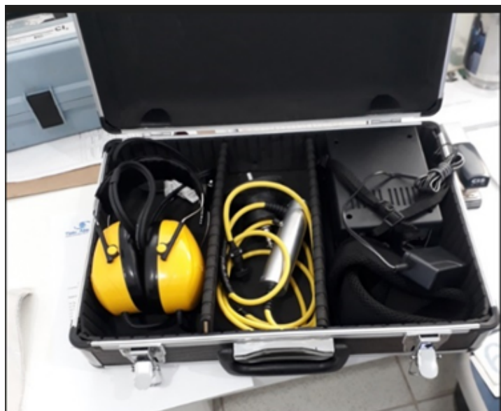
Figura 7 - Geofone eletrônico e mecânico utilizado pela Sabesp de Fernandópolis - SP
