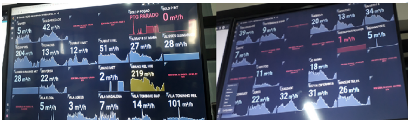
Figura 13 - Sistema de Telemetria empregado pelo SeMAE de São José do Rio Preto nos DMCs.
