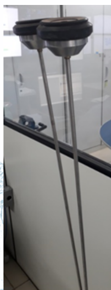
Figura 8 - Geofone eletrônico Xmic utilizado pelo SeMAE de São José do Rio Preto
