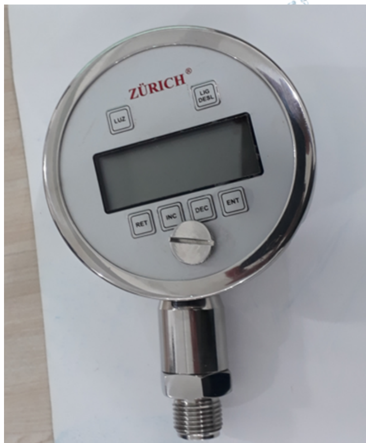
Figura 15 - Manômetro digital Zürich que coleta e armazena informações a respeito da pressão das redes.
