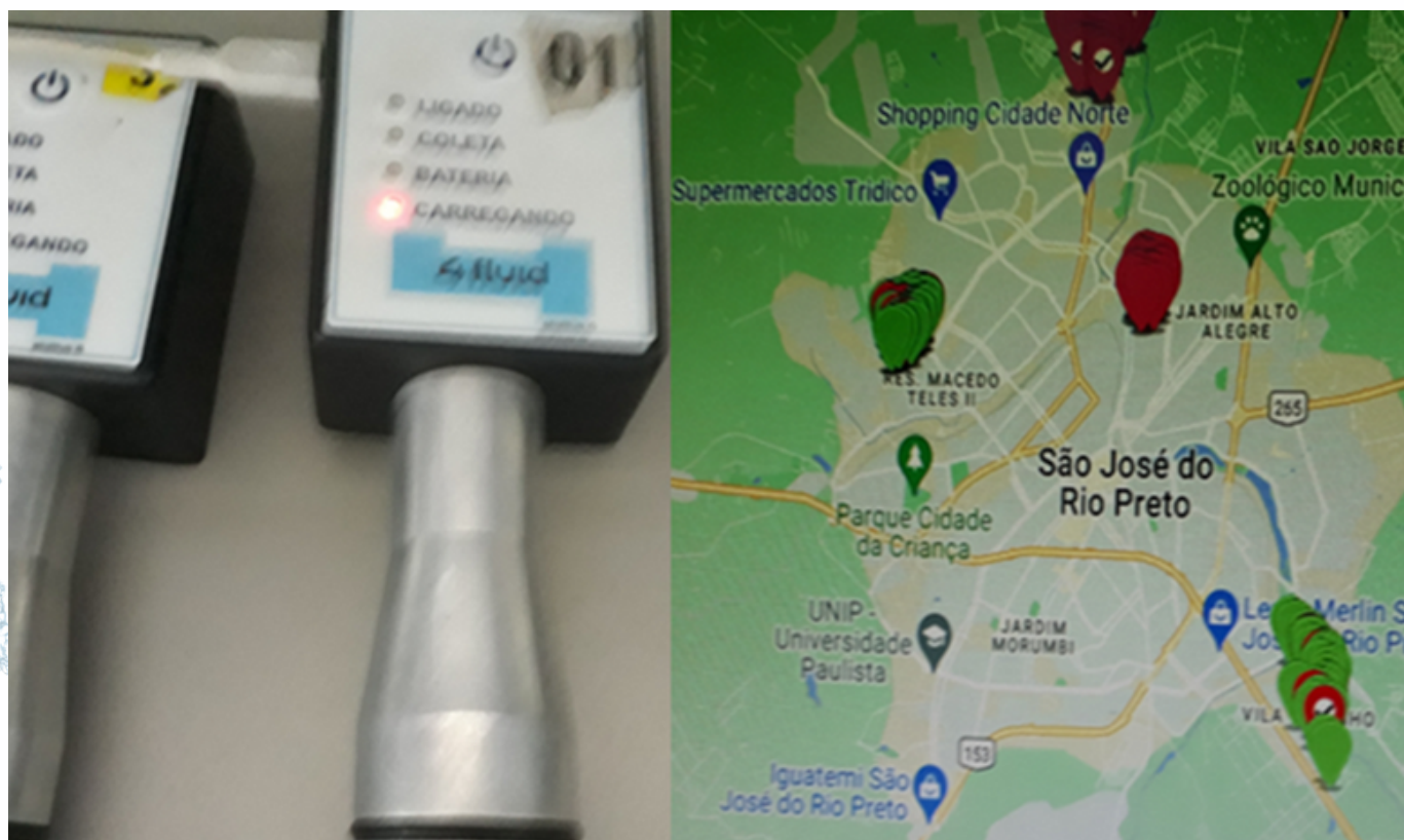
Figura 16 - Haste de escuta eletrônica com geolocalizador empregada pelo SeMAE de São José do Rio Preto -SP.
