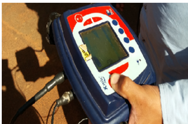
Figura 8 - Geofone eletrônico Xmic utilizado pelo SeMAE de São José do Rio Preto
