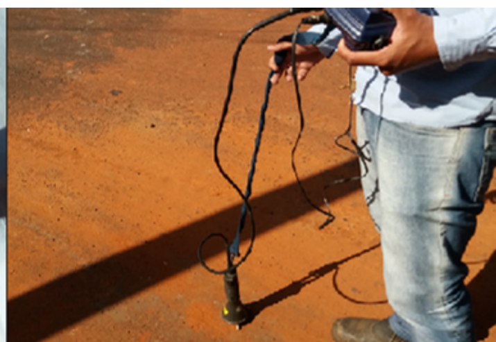
Figura 8 - Geofone eletrônico Xmic utilizado pelo SeMAE de São José do Rio Preto
