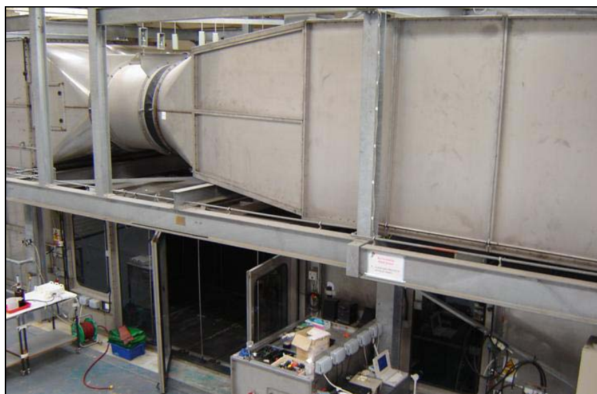
Figura 1. Túnel de vento para avaliação de deriva, pertencente ao laboratório do Silsoe Research Institute, Inglaterra.
