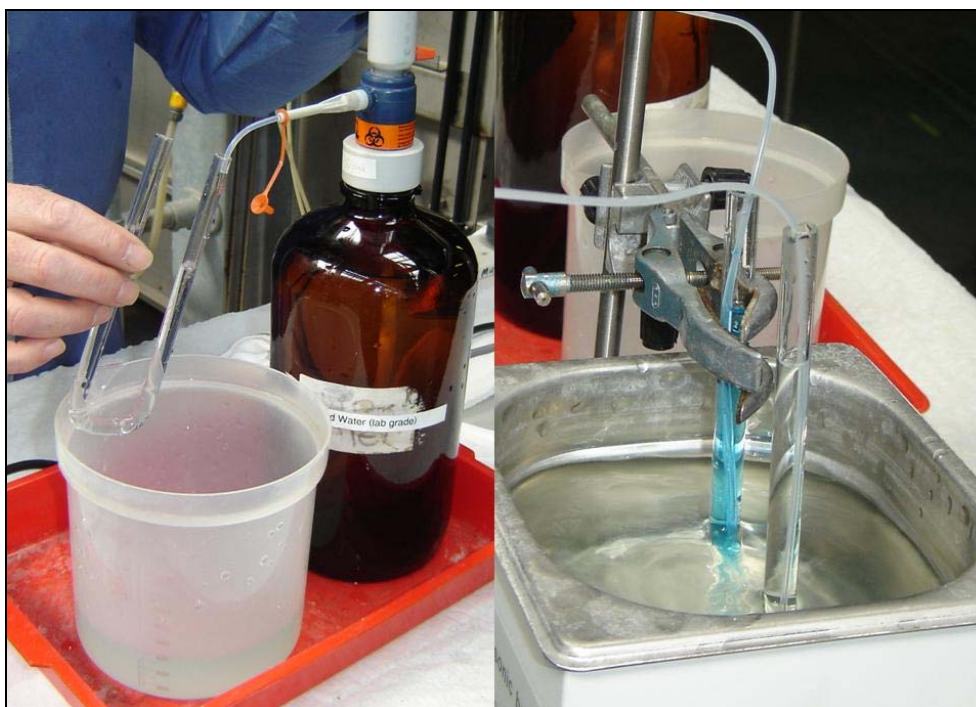
Figura 6. Lavagem dos fios de polietileno (coletores de deriva).
