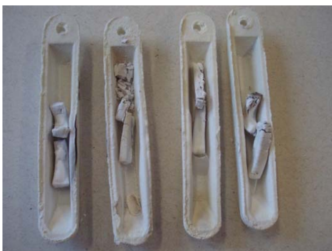
Figura 37 - Amostras de polímero após queima no bico de Bunsen.
