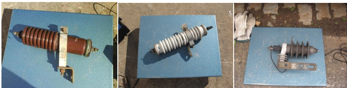
Figura 23 – Exemplos de para-raios encontrados: (a) parte isoladora feita de porcelana marrom, (b) parte isoladora feita de porcelana cinza, (c) parte isoladora feita de polímero.
