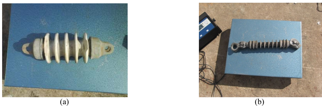
Figura 21 – Isoladores tipo bastão: (a) de cerâmica cinza, (b) de polímero.
