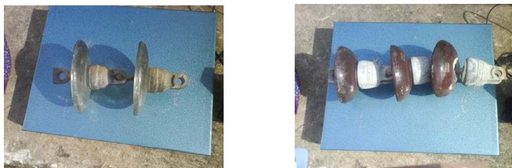
Figura 19 – Isoladores de discos feitos de vidro e de porcelana marrom.
