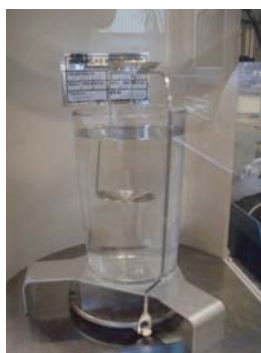
Figura 14 – Balança analítica com suporte estacionário para o recipiente de imersão utilizada no ensaio.
