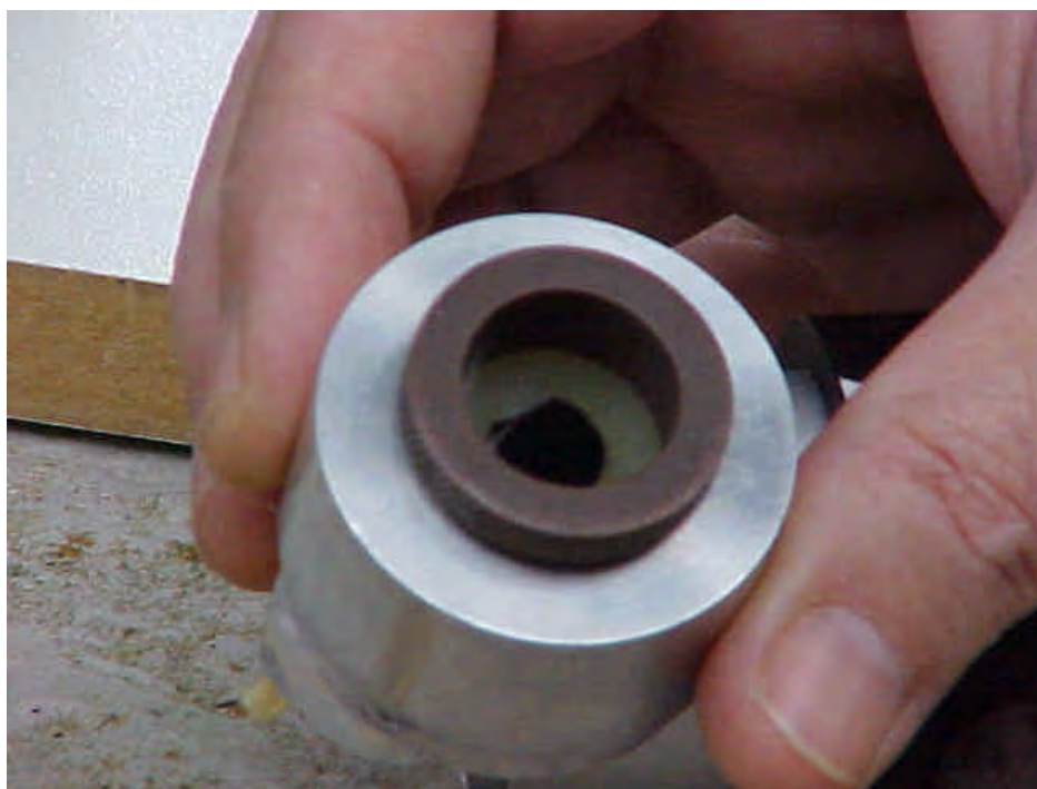
Fotografia 3.1: Vista frontal da célula fotoacústica evidenciando-se a janela de quartzo, anel de fixação da janela e amostra absorvedora.
