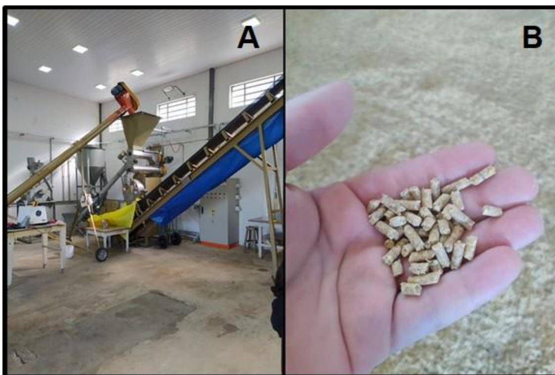
Figura 4: Peletizadora utilizada no preparo das rações experimentais e aspecto dos pellets obtidos.
