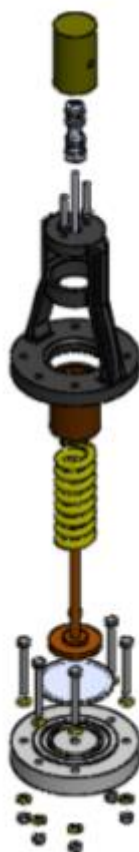
Figura 21 - Vista explodida da válvula piloto.
