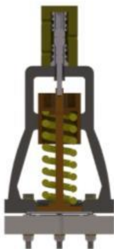
Figura 19 - Vista em seção da válvula piloto renderizada (1).
