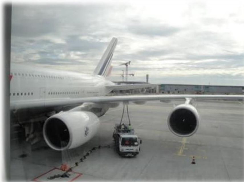
Figura 4 - Abastecimento de aeronave utilizando caminhão servidor (2).
