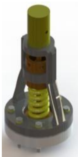
Figura 18 - Montagem da válvula piloto utilizando Solidworks® renderizada.
