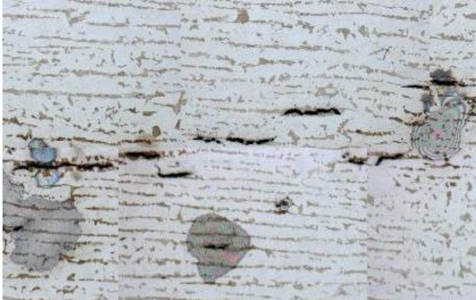
Figura 5 - Exemplo de metal com ocorrências de trincas induzidas por hidrogênio (HIC) e aspecto escalonado (SWC)
