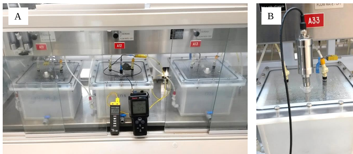
Figura 20 - Recipientes herméticos utilizados no preparo das soluções
