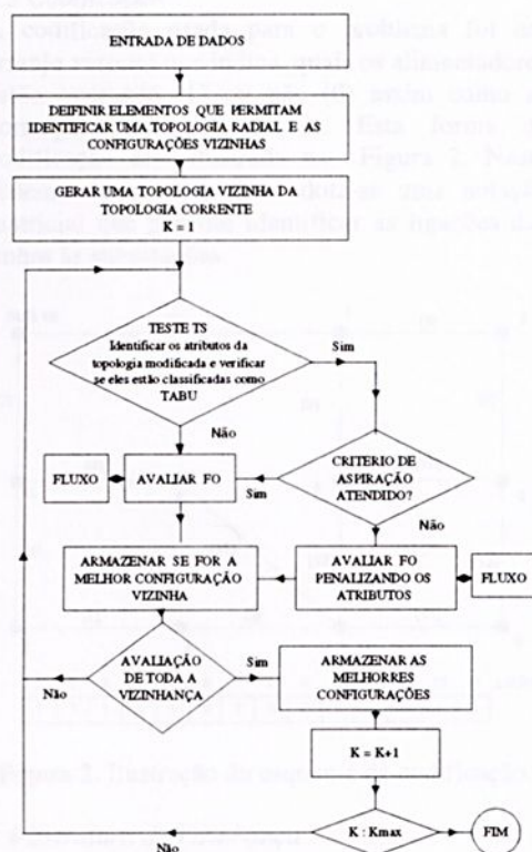
Figura 1. Diagrama de blocos do TS para o problema de planejamento.
