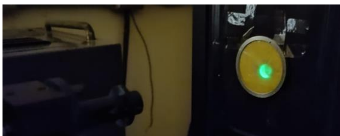
Figura 5 – Amostra do cintilador \text{ZnS:Ag} submetida a raios X de molibdênio 20 mA @ 40 kV.
