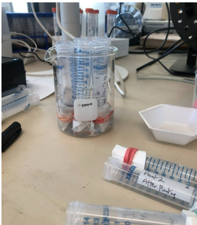
Figura 36. Tomada da CRA das amostras dos solos estudados
