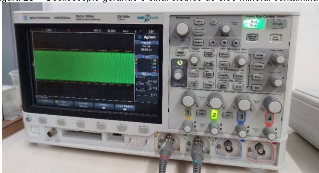
Figura 23 – Osciloscópio gerando o sinal elétrico do óleo mineral contaminado
