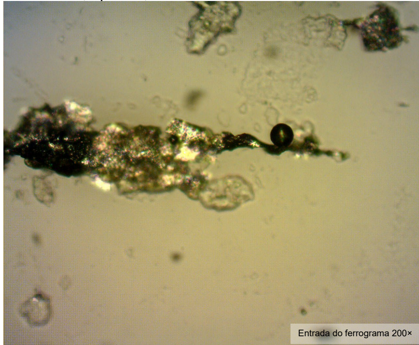
Figura 49 – Lâmina de ferrografia analítica contendo partículas contaminantes provenientes da amostra de óleo de redutor de velocidade de engrenagens helicoidais 12,5 para 1, modelo SUMITOMO SFC055R2GS RRF
