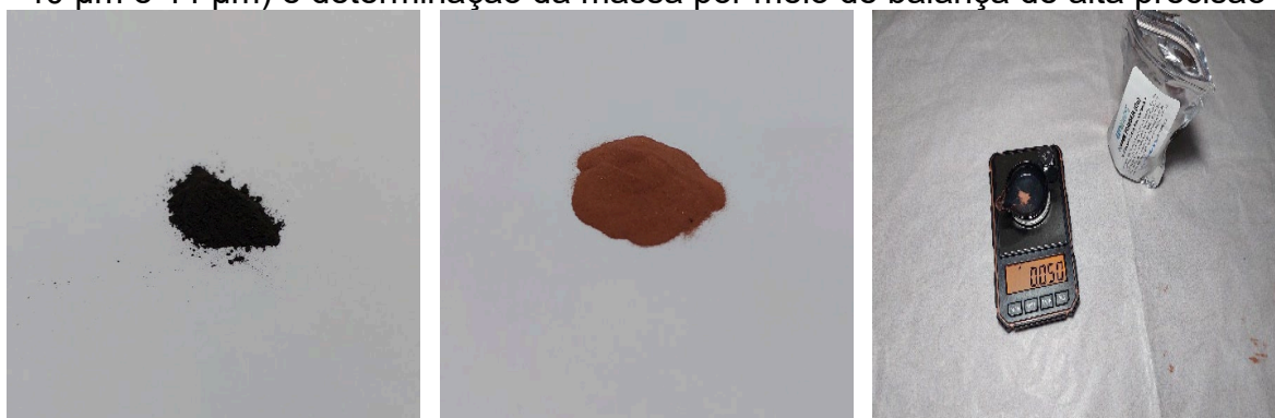
Figura 20 – Partículas de ferro e cobre correspondente à malha 325 (abertura entre 40 \mu\text{m} e 44 \mu\text{m} ) e determinação da massa por meio de balança de alta precisão
