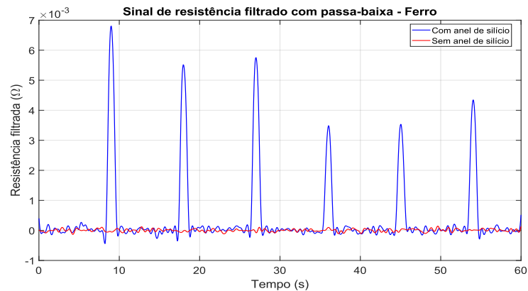
Figura 41 – Sinal resistivo com filtro passa-baixa para partículas ferrosas da amostra da bomba de alimentação de caldeira
