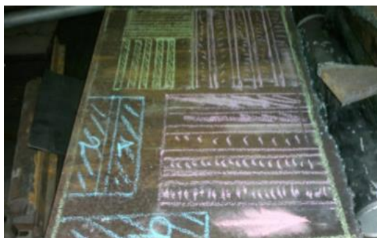
Figura 3.1 – Distribuição dos corpos-de-prova na chapa
