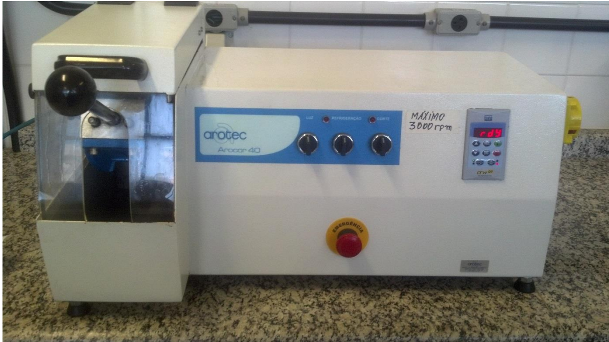
Figura 3.9 – Máquina cortadora marca Arotec modelo Arocor 40
