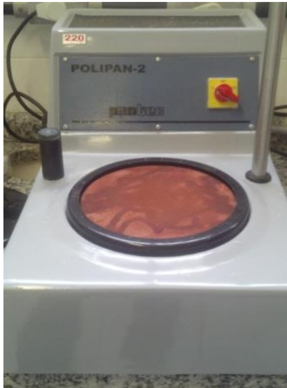
Figura 3.11 – Máquina politriz para polimento de amostras
