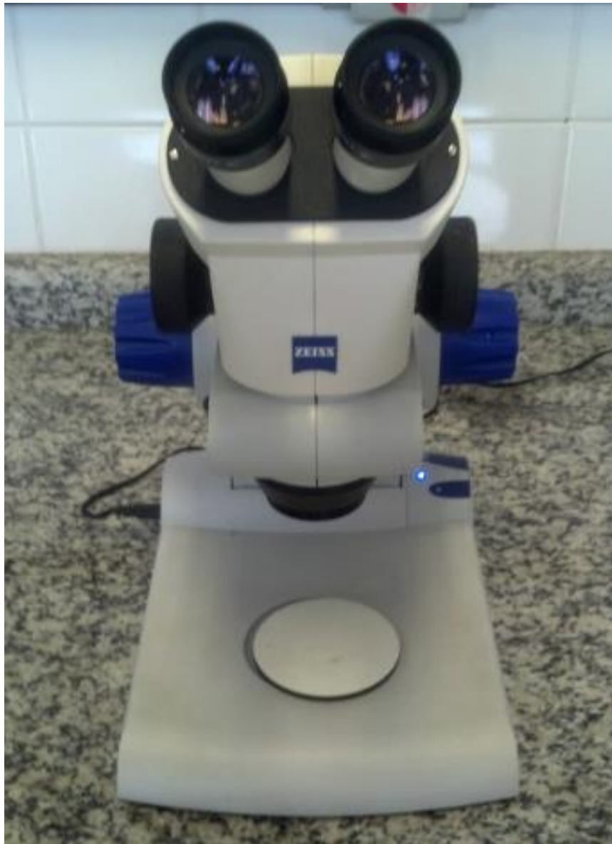
Figura 3.12 – Microscópio óptico da marca Carl Zeiss utilizado para verificação do lixamento e polimento
