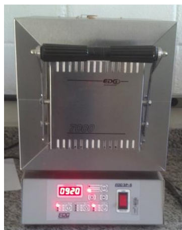
Figura 3.3 – Forno utilizado na austenitização à 920°C marca EDG modelo 7000 (FEG/UNESP)
