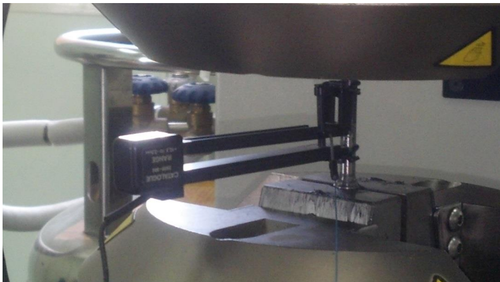
Figura 3.7 – Extensômetros fixados no comprimento útil do corpo-de-prova para medição do alongamento ( \epsilon )
