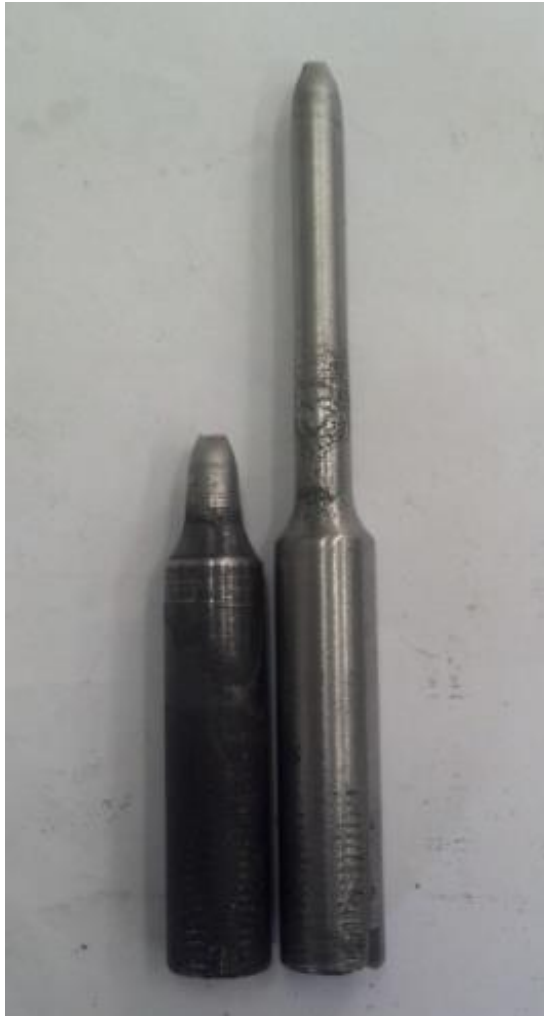
Figura 3.8 – Corpo-de-prova após ruptura devido aos esforços externos de tração
