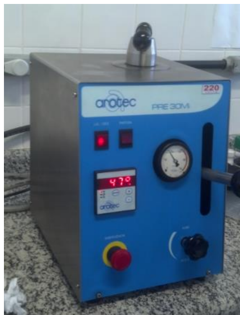
Figura 3.10 – Máquina prensadora para embutimento de amostras da marca Arotec modelo PRE 30 Mi
