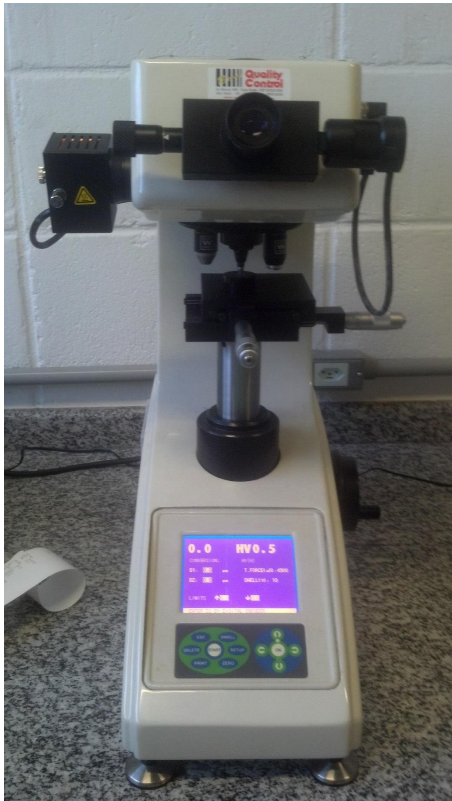
Figura 3.14 – Microdurômetro da marca Wilson modelo MVD 401, utilizado para medição de microdureza Vickers dos corpos-de-prova
