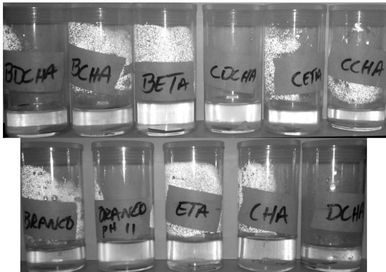
Figura 18 – Zinco metálico imerso em solução de NaCl 0,1 mol.L -1 na ausência e presença de VCI em concentração de 5 \times 10^{-3} mol.L -1 .
