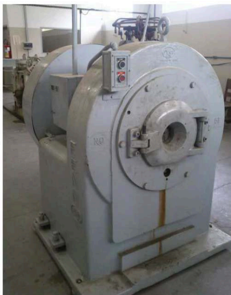
Figura 15 - Prensa rotativa empregada para obtenção das ligas.
