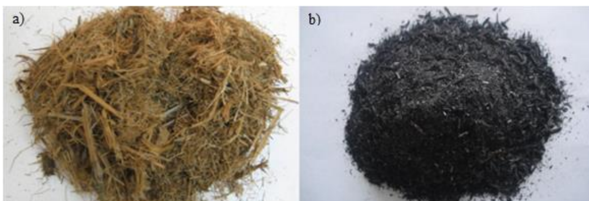
Figura 14 – a) Bagaço de cana; b) cinza de bagaço de cana.
