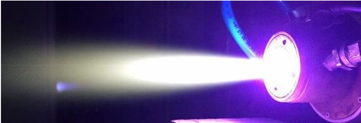
Figura 12 – Plasma gerado com mistura de ar e gás natural por tocha utilizada no estudo.
