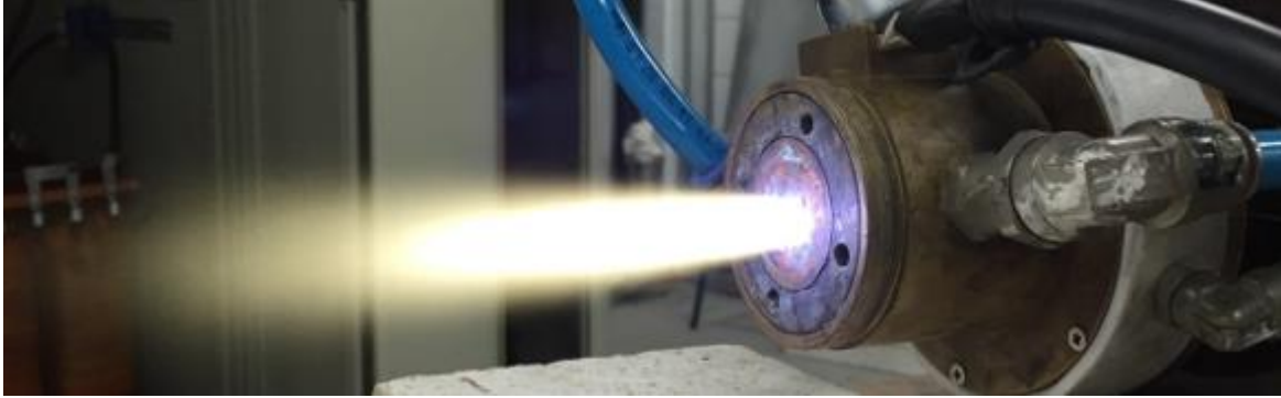
Figura 5 – Plasma gerado por uma tocha de corrente contínua e arco não transferido.
