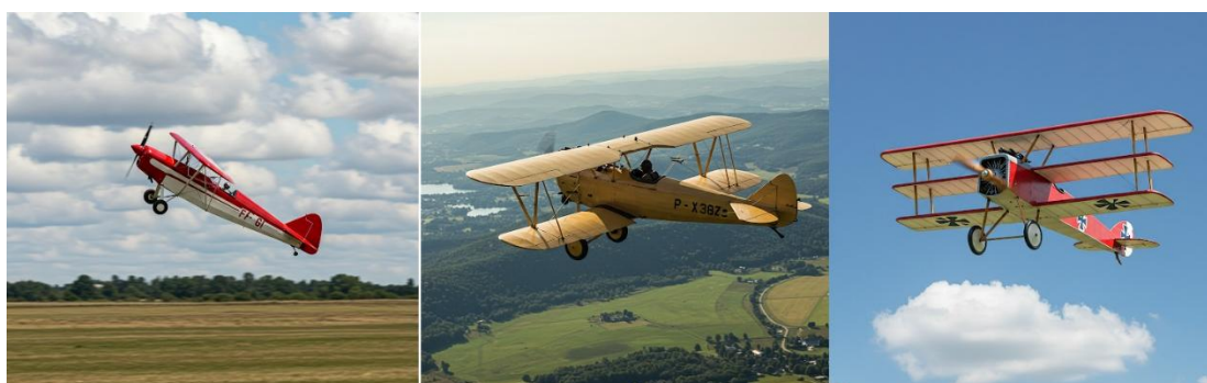
Figura 1 - Monoplano, Biplano e Triplano
