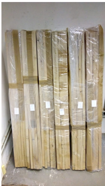
Figura 17 – Lamelas secas até 12% de umidade Fonte: Autor
