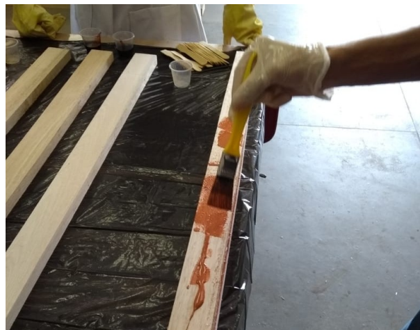
Figura 21 – Aplicação do adesivo nas lamelas Fonte: Autor
