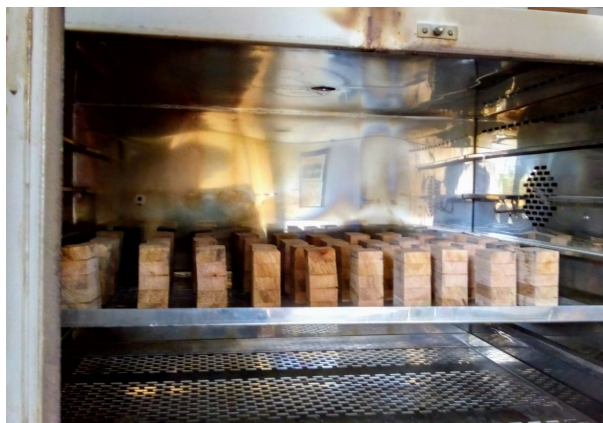
Figura 26 – Corpos de prova durante o processo de secagem Fonte: Autor
