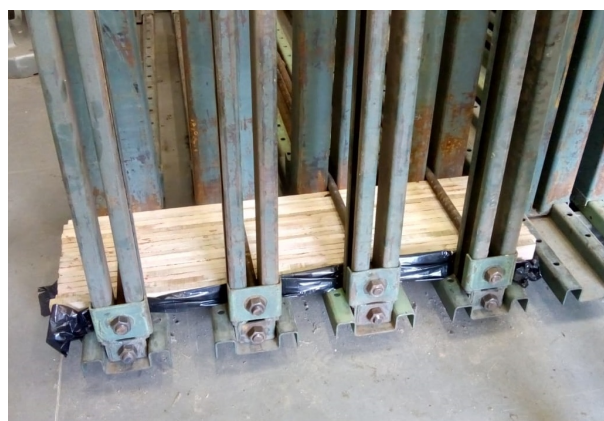
Figura 22 – Prensagem das vigas Fonte: Autor
