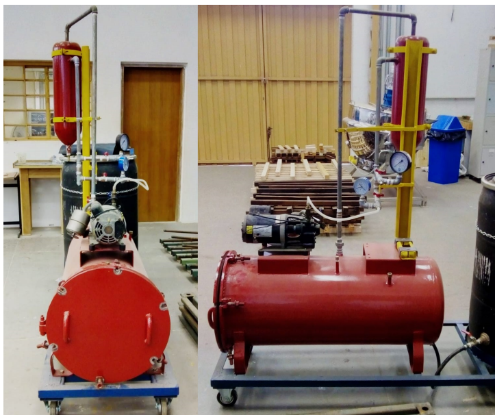
Figura 24 – Autoclave construída para os ensaios de delaminação Fonte: Autor
