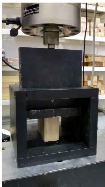
Figura 28 – Dispositivo para os ensaios de resistência ao cisalhamento da linha de cola Fonte: Autor
