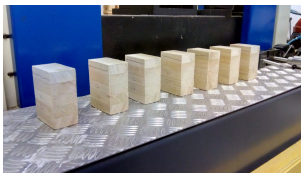
Figura 27 – Corpos de prova de cisalhamento do elemento 1 de MLC Fonte: Autor
