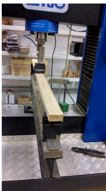
Figura 20 – Ensaio de flexão estática não-destrutiva Fonte: Autor
