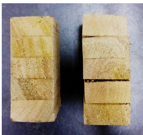
Figura 29 – Resultado do ensaio de delaminação Fonte: Autor
