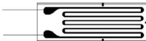
Figura 11 - Extensômetro de Lâmina (Fialho, 2002)
