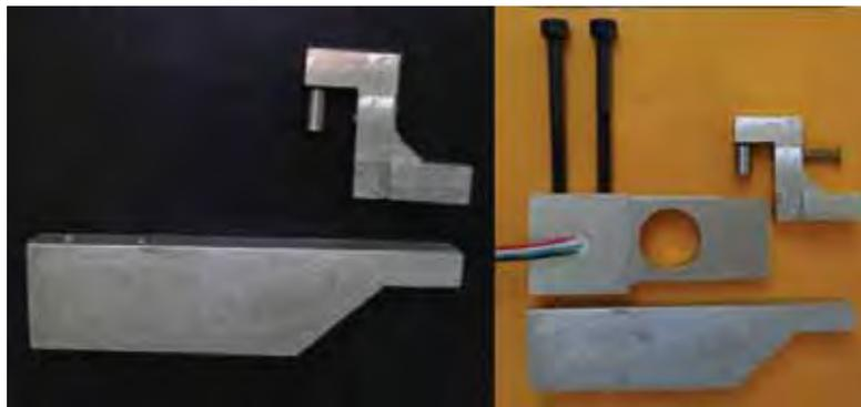
Figura 20 – Peças Usinadas e prontas para montagem
