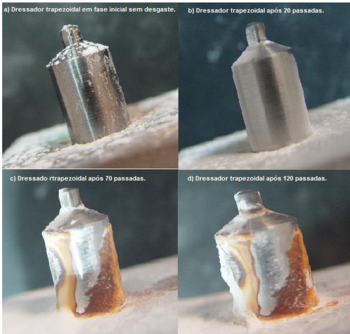
Figura 40. Imagens do dressador trapezoidal: (a) Sem desgaste; (b) após 20 passadas; (c) após 70 passadas; (d) após 120 passadas
