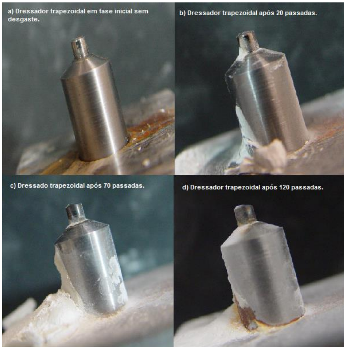
Figura 53. Imagens do dressador trapezoidal: (a) Sem desgaste; (b) após 20 passadas; (c) após 70 passadas; (d) após 120 passadas.
