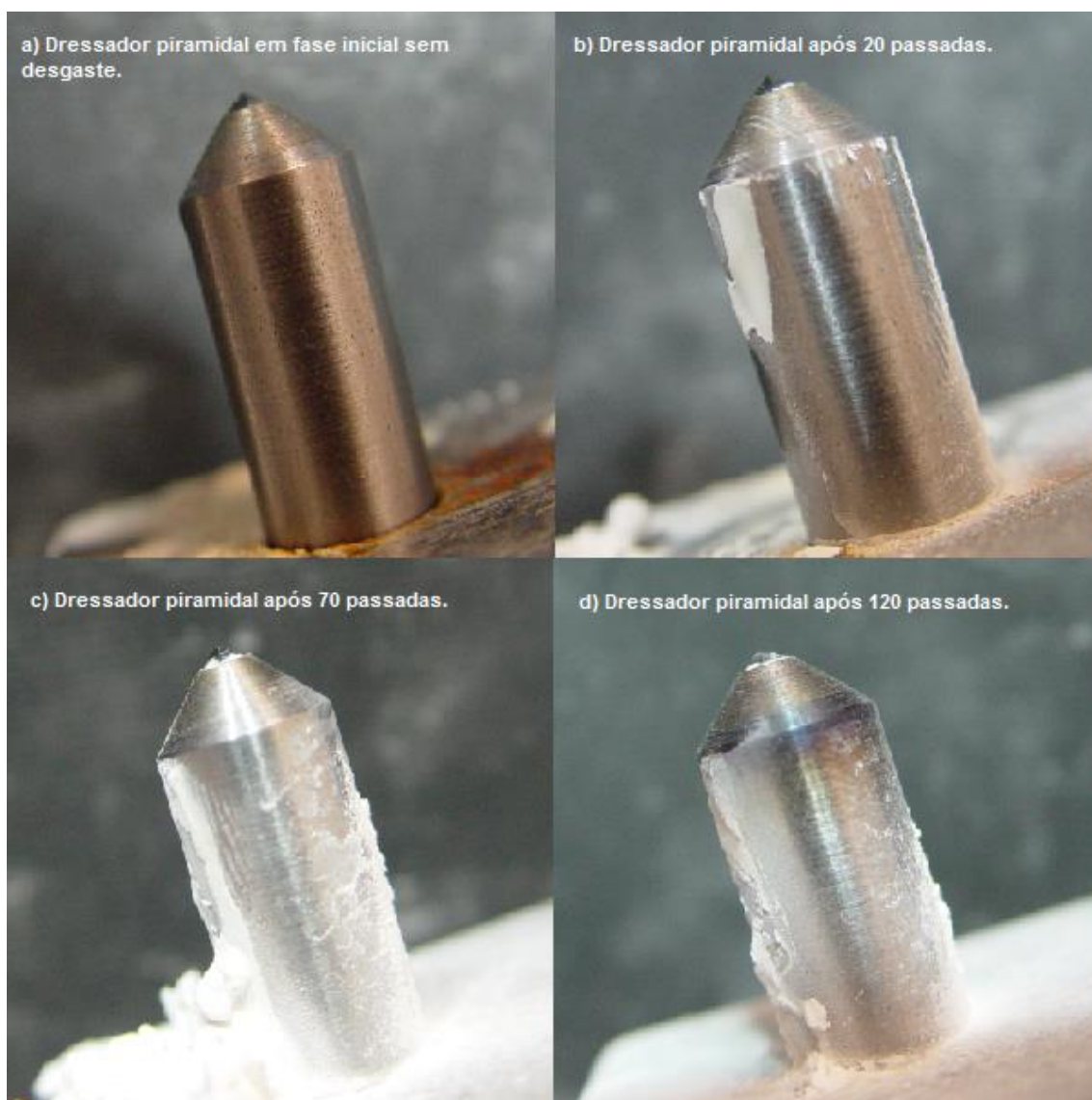
Figura 59. Imagens do dressador piramidal: (a) Sem desgaste; (b) após 20 passadas; (c) após 70 passadas; (d) após 120 passadas.
