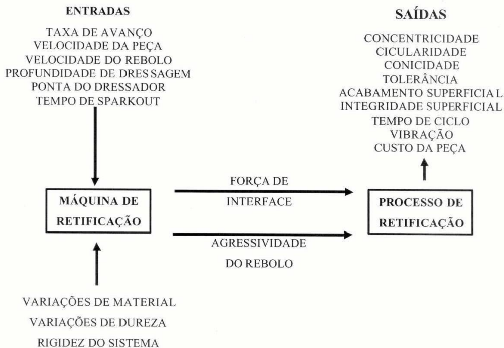
Figura 22. Relações do processo de retificação (Adaptado – Doman, et al 2006).
