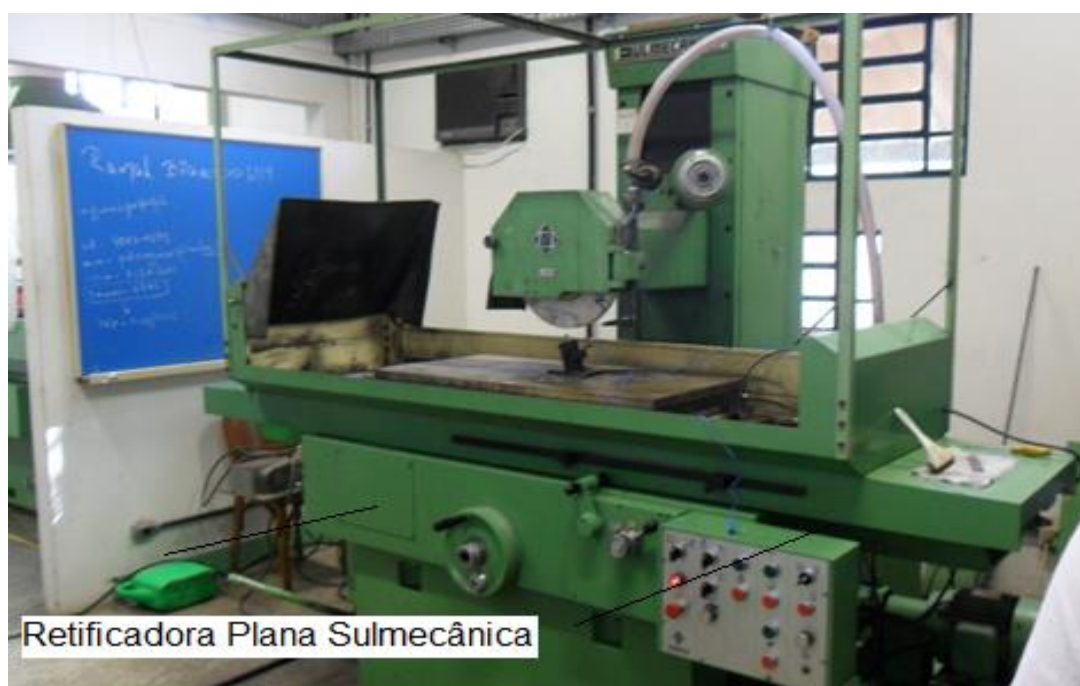
Figura 23. Máquina retificadora plana modelo 1055E fabricada pela empresa SULMECÂNICA utilizada nos ensaios de dressagem.
