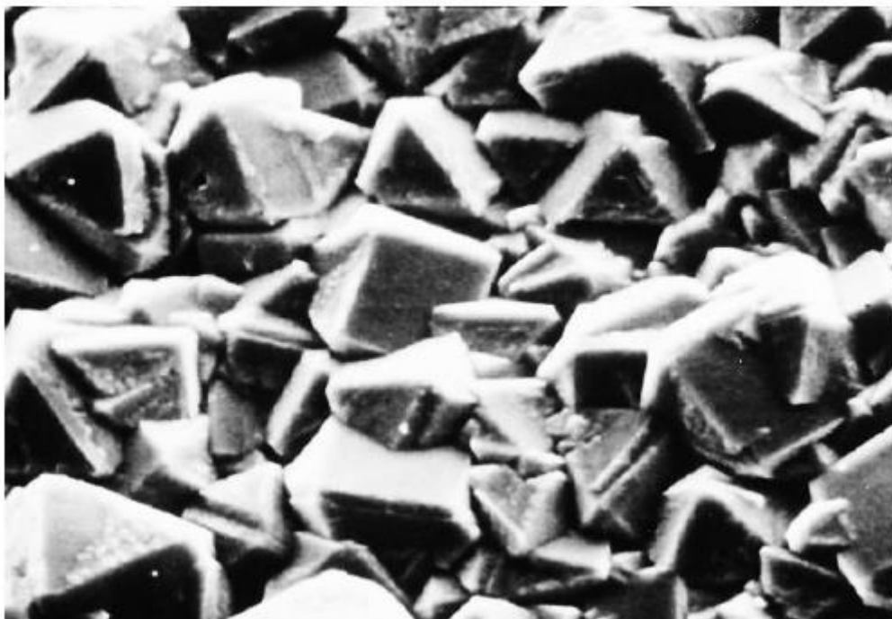
Figura 11. . Micrografia eletrônica por varredura de um filme fino de diamante onde são mostrados numerosos micro cristais multifacetados (CALLISTER, 2013 - adaptado).
