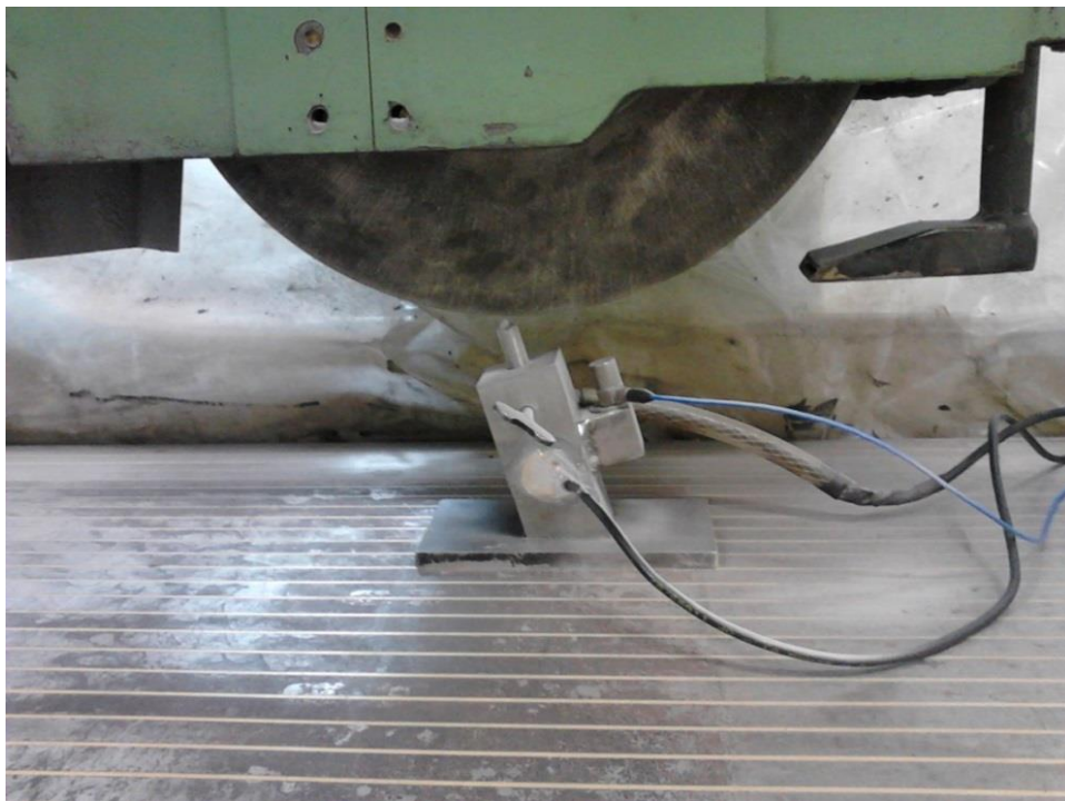
Figura 30. Ensaio com o dressador composto pelo diamante trapezoidal.
