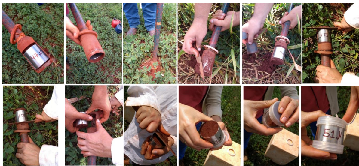
Figura 6. Sequência da coleta e preparação das amostras de solo com o anel volumétrico - amostra indeformada.
