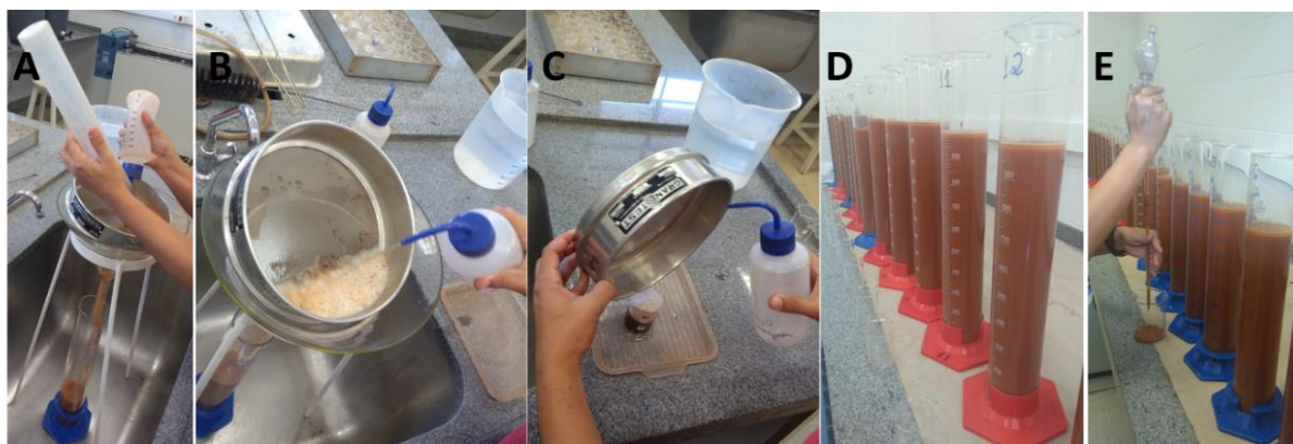
Figura 5. Etapas da análise de textura do solo. (A e B) Lavagem da amostra, (C) separação da fração de areia da amostra, (D) conteúdo remanescente da separação da fração areia, (E) pipetagem da fração de argila.
