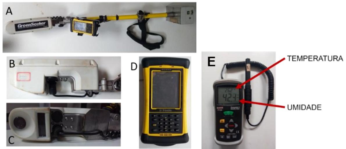
Figura 6. Sensor GreenSeeker®. (A) Visão geral, (B) sensor, (C) detalhe das lentes, (D) Nomad, (E) Medidor de temperatura e umidade da marca Instrutherm, modelo HT-350.
