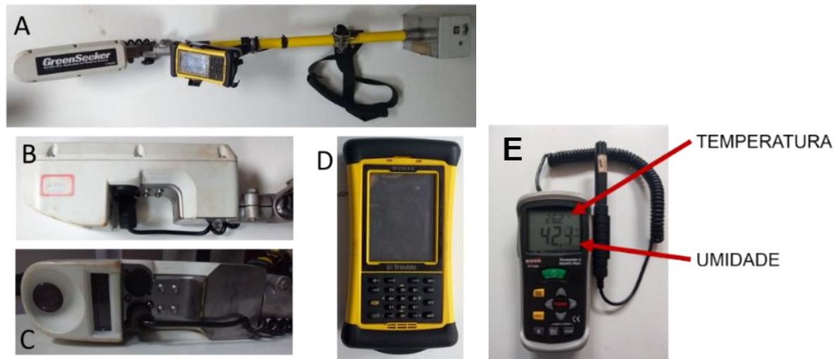
Figura 3. Sensor GreenSeeker®. (A) Visão geral, (B) sensor, (C) detalhe das lentes, (D) Nomad, (E) Medidor de temperatura e umidade da marca Instrutherm, modelo HT-350.
