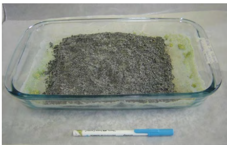
Figura 10. Lixiviação ácida da escória realizada em pilha.
