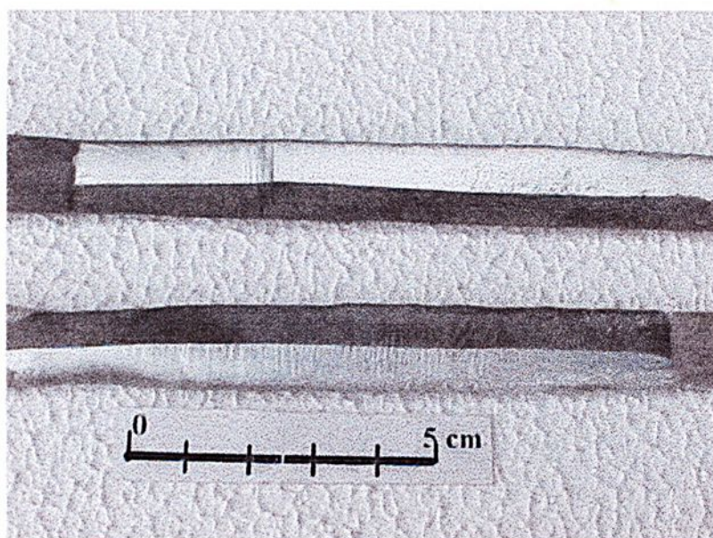
FIGURA 37 - Fotomacrografia das 2 barras de estanho, obtidas pelo processo de simples fusão zonal “MGE” com fluxo de gás. Observa-se a presença do monocristal na extremidade da barra.
