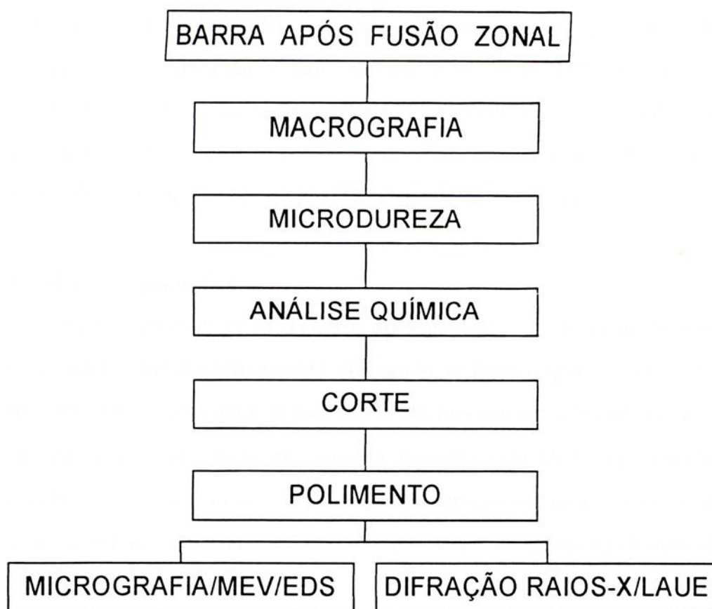
FIGURA 27 - Fluxograma para análises e exames dos corpos-de-prova.
