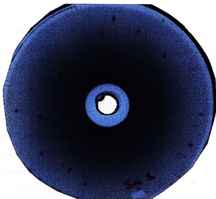
FIGURA 45 – Difratoograma de raios-X pelo método Laue da posição 1.
