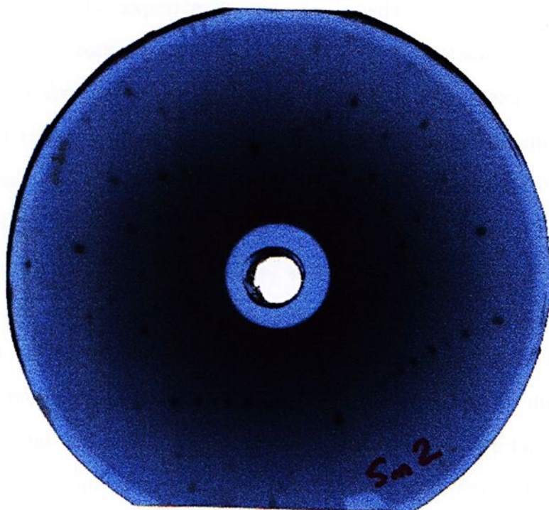
FIGURA 46 – Difratoograma de raios-X pelo método Laue da posição 2.
